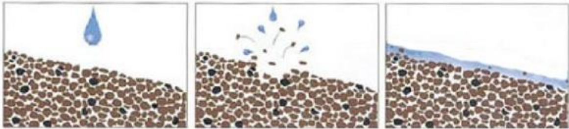
Figura 7: Efeito “ splash ” no solo sem cobertura vegetal. Fonte: Fontanailles, 2013.
