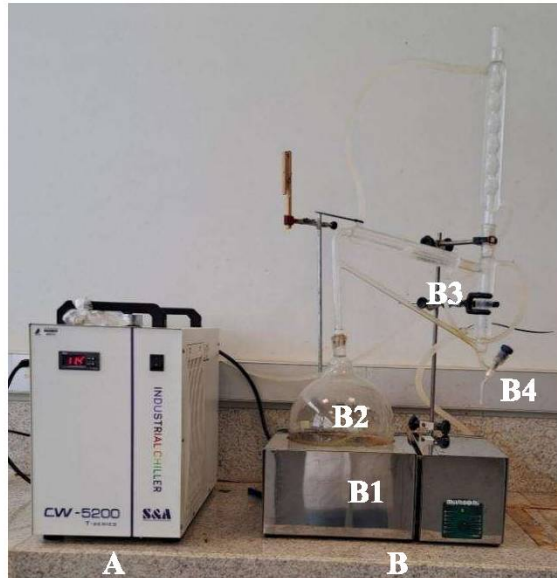
FIGURA 18 – PROCEDIMENTO DE EXTRAÇÃO DE ÓLEO ESSENCIAL EM DESTILADOR CLEVINGER ACOPLADO A CHILLER
