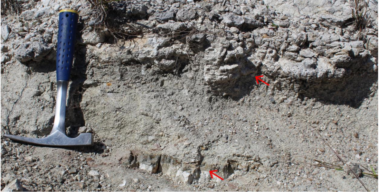
Figura 3.12 – Camada de areia maciça em meio ao calcarete maciço. A porção de Sm não reage ao HCl 10%, e tem seus limites marcados por argilas maciças em contato abrupto (tectônico?) com o calcarete (setas vermelhas). Local: porção inferior do perfil CP1.
