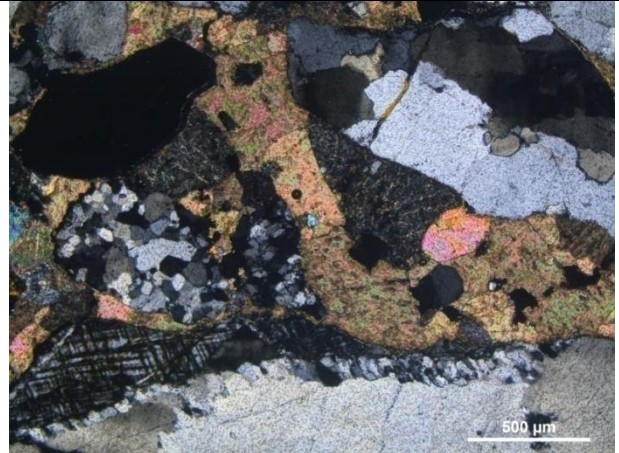
Grãos de quartzo, granada e litoclastos envolvidos por carbonato esparítico. Fotomicrografia com polarizadores cruzados.
