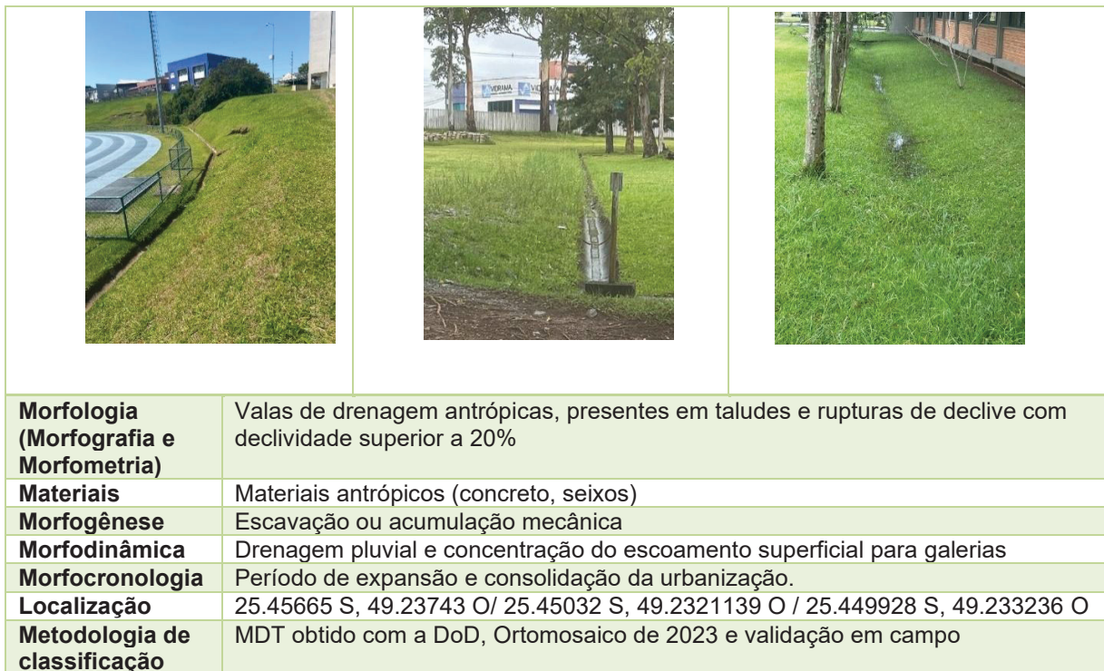
Figura 40 - Tecnoforma de Escavação e/ ou acumulação: valas de drenagem antrópica. Foto: A autora (2025)
