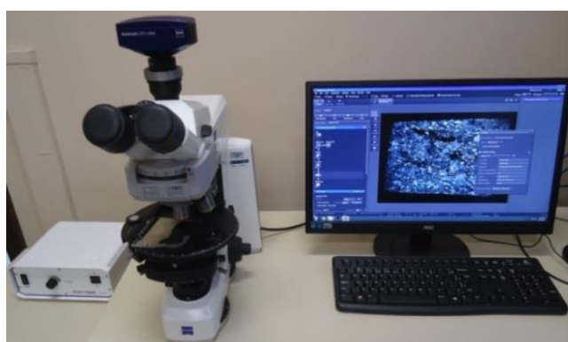
Figura 8: Microscópio de luz transmitida da marca Axio Scope Zeiss e software de aquisição de imagem Zen 2.3 lite.
