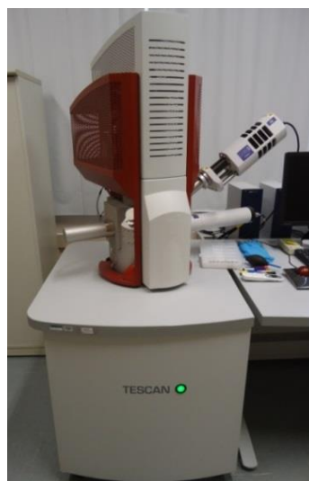
Figura 12: Equipamento MEV tipo FEG (Field Emission Gun) modelo Mira3 LM da marca Tescan situado no LAME/LACTEC.
