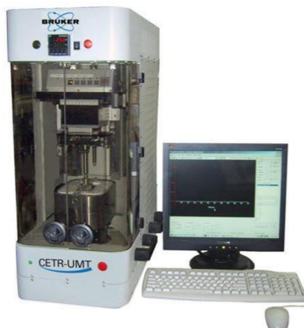
Figura 10: Sistema do teste do micro tribômetro de modelo UMT da Buker. Retirado de Buker UMT Manual User.
