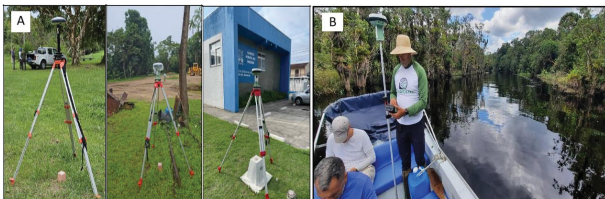
FIGURA(7A) ESTAÇÕES DE PONTOS BASE INSTALADAS NOS RIOS GUARAGUAÇU E NHUNDIAQUARA; (7B) COLETA DE ALTITUDE DO ESPELHO DE ÁGUA NO RIO GUARAGUAÇU.
