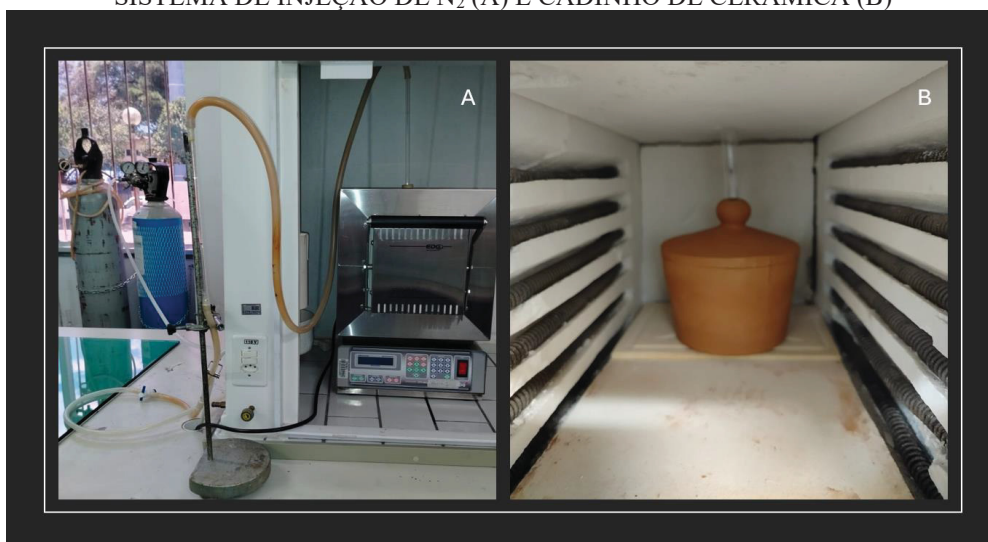
FIGURA 10 - SISTEMA COMPLETO DO PROCESSO DA PIRÓLISE LENTA, FORNO MUFLA E SISTEMA DE INJEÇÃO DE N_2 (A) E CADINHO DE CERÂMICA (B)
