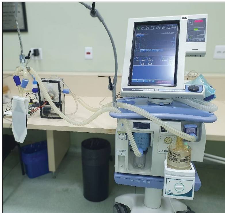
FIGURA 10 - ESQUEMA DE CONEXÕES DOS TESTES HOSPITALARES
