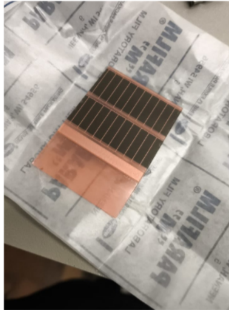
FIGURA 26 – Painel fotovoltaico orgânico (OPV) utilizado nos experimentos deste estudo, pertencente ao Grupo de Dispositivos Nanoestruturados (DiNE). O módulo apresenta área total de 49,8 \times 125,6 cm e área ativa estimada de 1056 cm 2 . Fonte: autoria própria.
