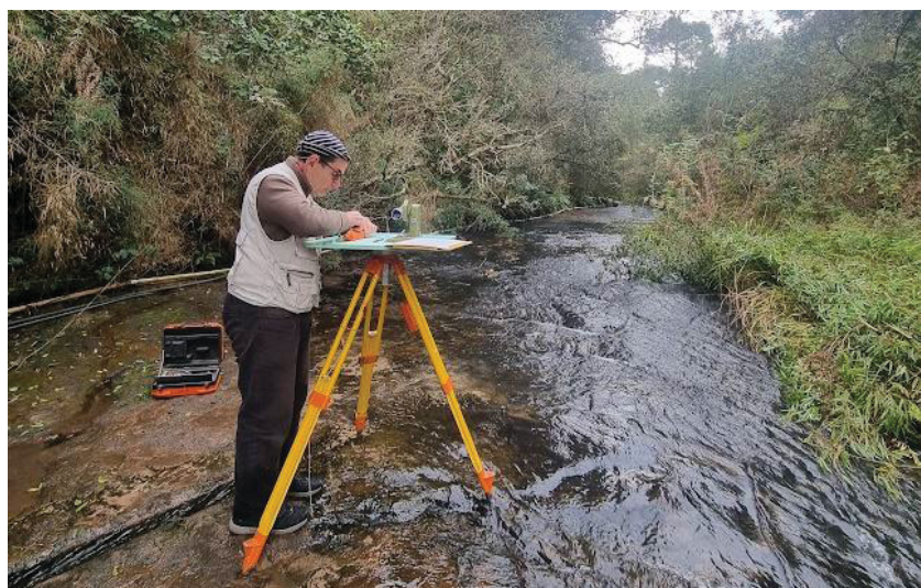
FIGURA 41 - FOTO DA INSTALAÇÃO DA ESTRUTURA DO ALIDADE
