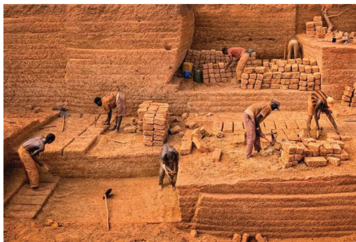
FIGURA 6 – TÉCNICA DE CONSTRUÇÃO COM TERRA: CORTAR
