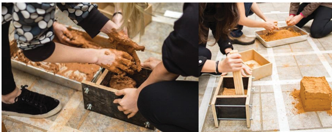
FIGURA 28 - PREPARO E COMPACTAÇÃO TERRA
