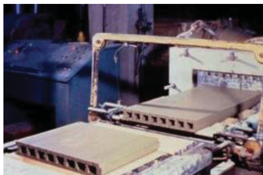
FIGURA 11 – TÉCNICA DE CONSTRUÇÃO COM TERRA: EXTRUDAR
