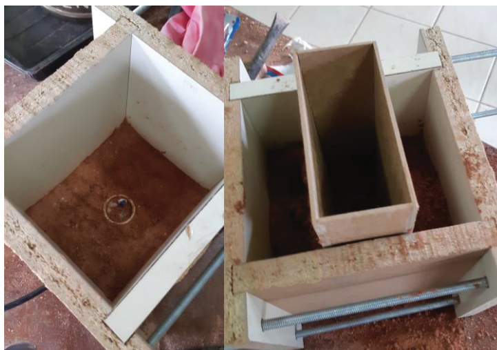
FIGURA A4- 1ª CAMADA DE TERRA E FORMA MENOR
