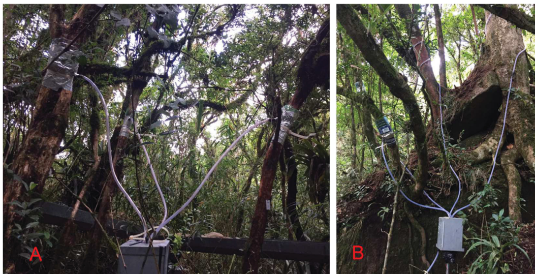
FIGURA 17 – SISTEMA DE COLETA DE ESCOAMENTO DE TRONCO DAS PARCELAS “A” E “B”.
