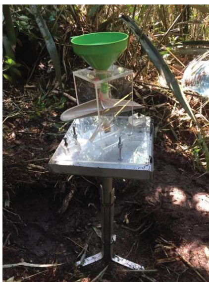
FIGURA 15 – BÁSCULAS PARA A MEDIÇÃO DA PRECIPITAÇÃO INTERNA (MODELO LHG-SB002-60CC) E SUPORTE PARA FIXAÇÃO NA ROCHA INSTALADA NA PARCELA A.
