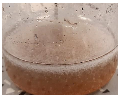
Figura 3.6 – Diferença aparente de densidade entre as resinas Legenda: Resinas catiônicas (fundo) e resinas aniônicas (superfície) separadas por diferença de densidade, quando do uso simultâneo das resinas.
