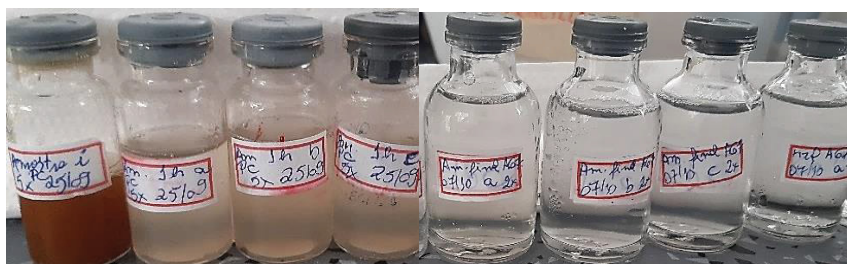
Figura 3.5 – Amostras para os ensaios em colunas Legenda: à esquerda: amostras antes do processo de purificação com resinas; à direita: amostras translúcidas após o processo de purificação com as resinas
