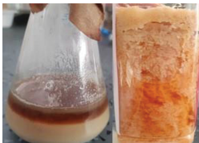
Figura 2.5 – Comparação visual do caldo fermentado contendo lactato de cálcio Legenda: à esquerda: aspecto de separação em fases do caldo fermentado, durante as 72 horas iniciais de fermentação; à direita: aspecto de bloco sólido do caldo fermentado, a partir de 96 horas de fermentação.
