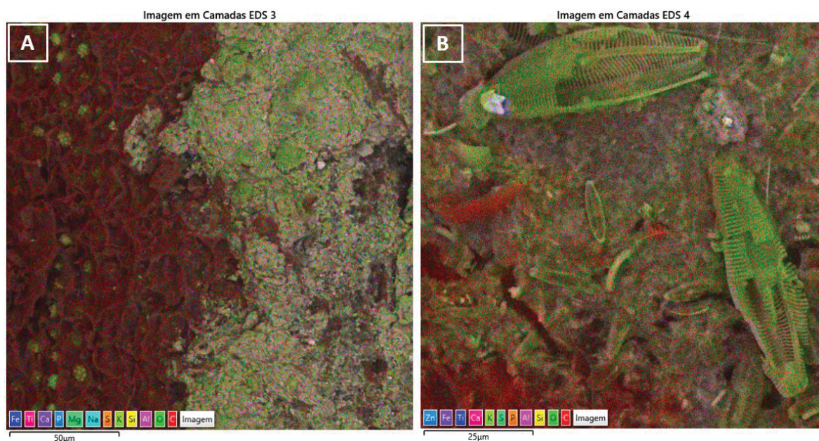
FIGURA 42 – IMAGENS DE EDS PARA A AMOSTRA 1 DE CARVÃO INOCULADO ENTRE 1,00 E 2,0 MM NAS ÁREAS 1 (A) E 2 (B) APRESENTANDO PRESENÇA DE ENXOFRE, FERRO, ALUMÍNIO, OXIGÊNIO, SILÍCIO E CARBONO COMO PRINCIPAIS SUBSTÂNCIAS.
