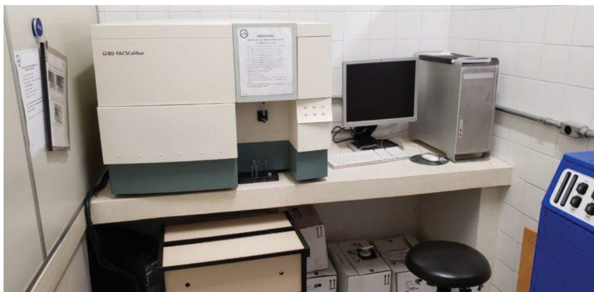
FIGURA 27 – CITOMETRO DE FLUXO MARCA BD BIOSCIENCES, MODELO FACS CALIBUR™.
