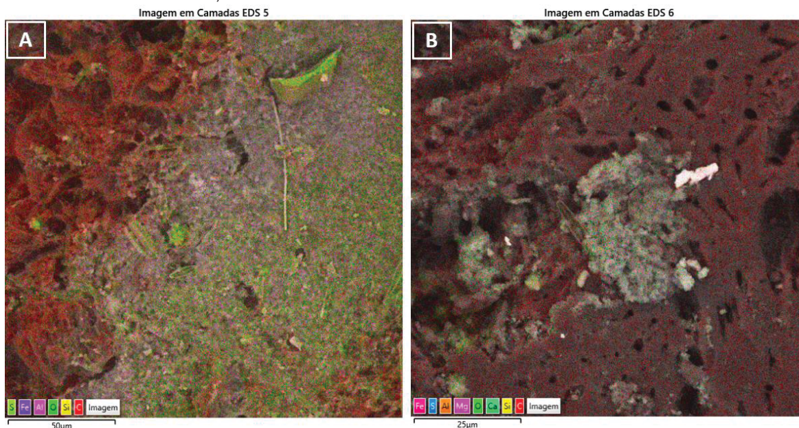
FIGURA 44 – IMAGENS DE EDS PARA A AMOSTRA 2 INOCULADA DE GRANULARIDADE ENTRE 1,00 E 2,0 MM APRESENTANDO NA IMAGEM PRESENÇA DE ENXOFRE, FERRO, ALUMÍNIO, OXIGÊNIO, SILÍCIO E CARBONO COMO PRINCIPAIS SUBSTÂNCIAS.
