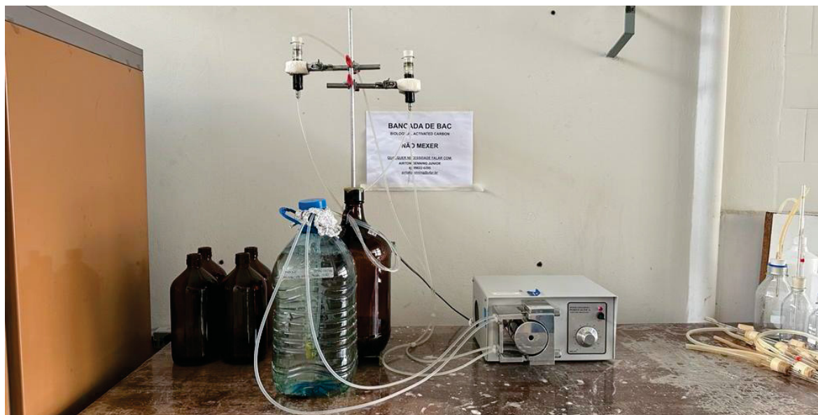
FIGURA 30 – INOCULAÇÃO DO BIOFILME NOS LEITOS DE CAB COM O USO DE BOMBA PERISTÁLTICA.
