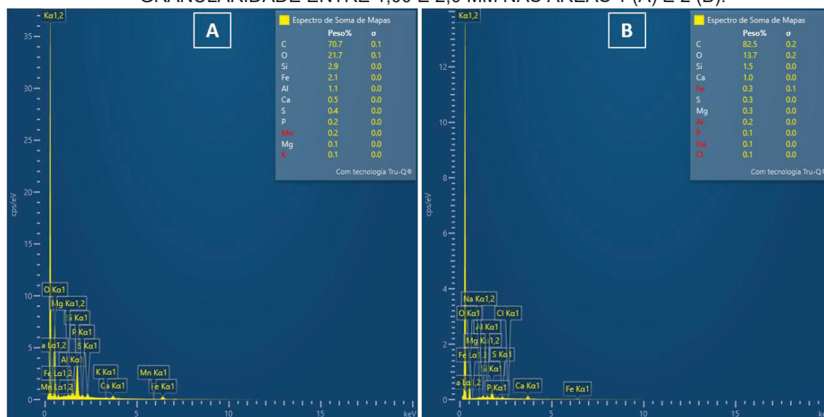
FIGURA 45 – RESULTADOS DE EDS PARA A AMOSTRA 2 DE CARVÃO INOCULADO DE GRANULARIDADE ENTRE 1,00 E 2,0 MM NAS ÁREAS 1 (A) E 2 (B).
