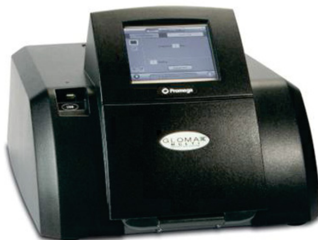
FIGURA 28 – LEITOR PARA ANÁLISE DE ATP MARCA PROMEGA, MODELO GLOMAX®MULTI E8032.
