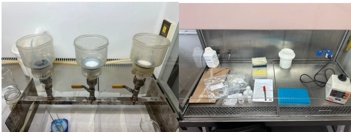
FIGURA 25 – FILTRAGEM (ESQUERDA) E EXTRAÇÃO (DIREITA) DE DNA DAS AMOSTRAS DE BIOFILME, CARVÃO INOCULADO E CARVÃO VIRGEM.
