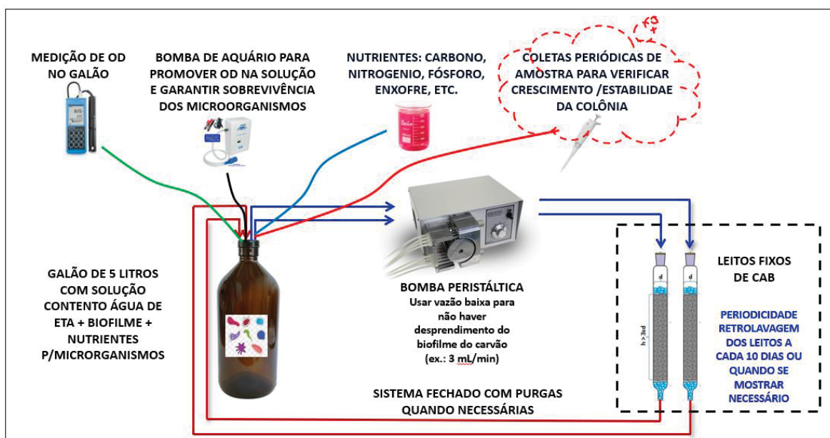
FIGURA 24 – CONFIGURAÇÃO DO PROCESSO DE INOCULAÇÃO DO CARVÃO ATIVADO BIOLÓGICO.
