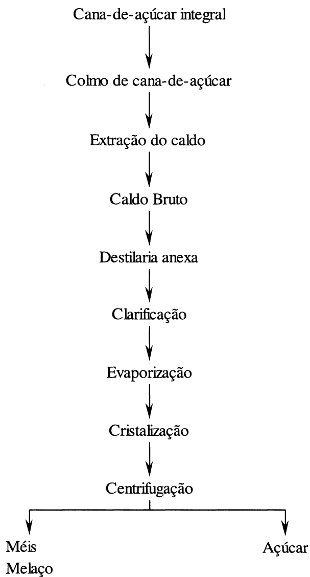
FIGURA 5 – FLUXOGRAMA DA PRODUÇÃO DE MELAÇO DE CANA-DE-AÇÚCAR.
