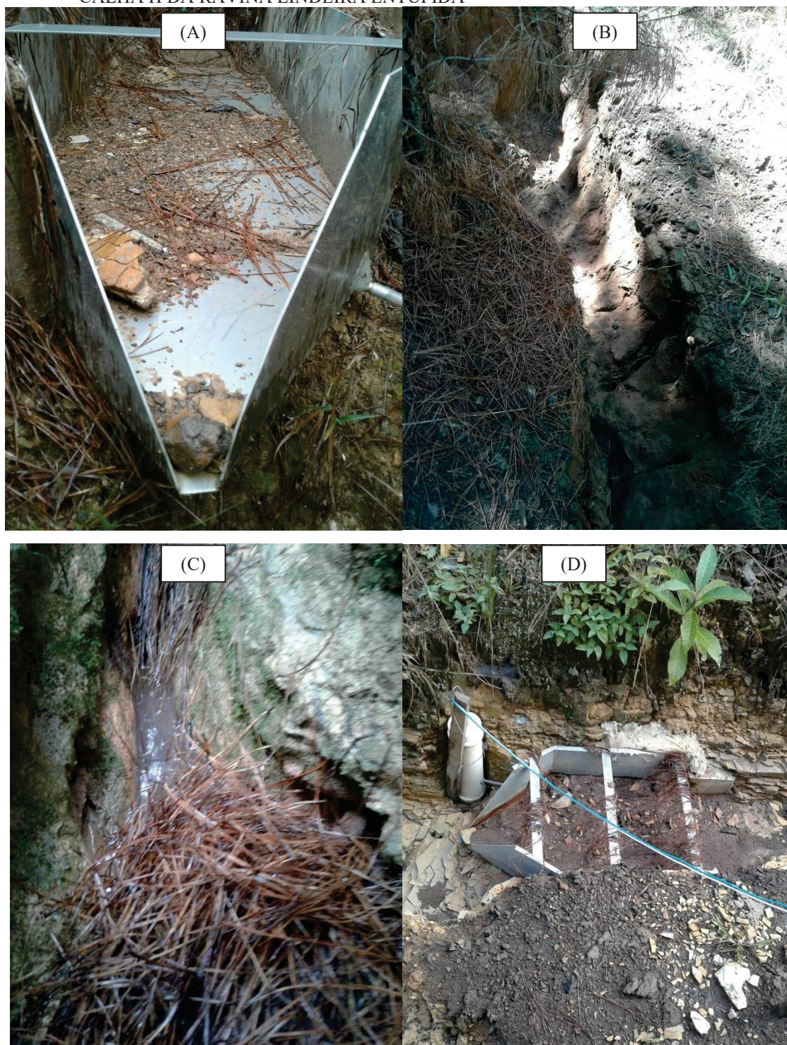
FIGURA 46 - RAVINA COM PINUS ONDE OBSERVA-SE (A) A PRESENÇA DE ACÍCULAS NO INTERIOR DA CALHA H, COM DEPÓSITOS DE SEDIMENTOS EM SUAS IMEDIAÇÕES; (B) SOLO COBERTO COM ACÍCULAS NA SUPERFÍCIE DA ESTRADA AO REDOR DA RAVINA; (C) AMONTOADO DE ACÍCULAS EM UM ESTREITAMENTO DA RAVINA COM PINUS ; E (D) CALHA H DA RAVINA LINDEIRA ENTUPIDA
