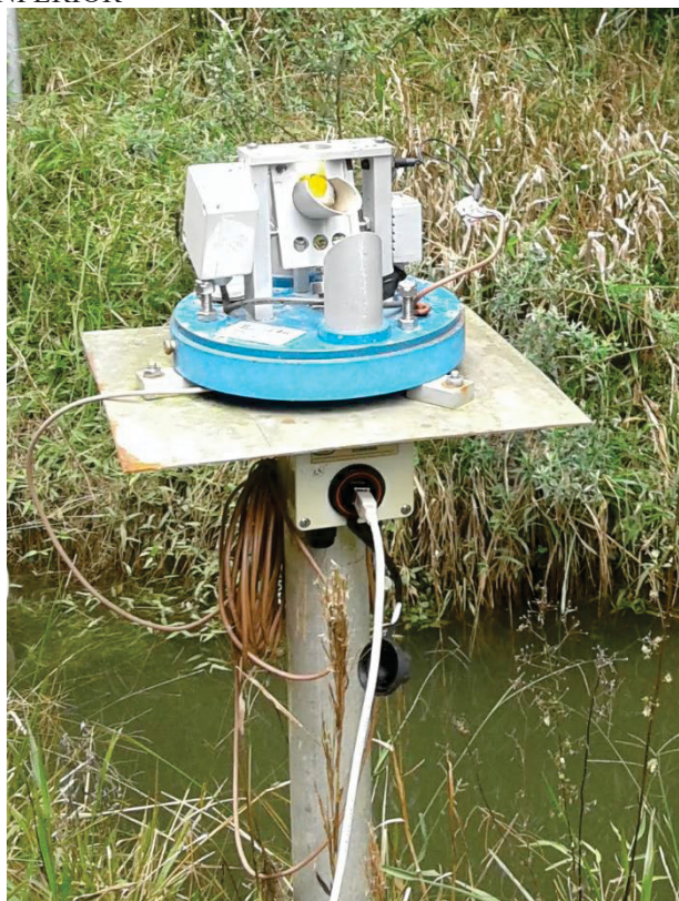
FIGURA 20 – PLUVIÔMETRO DE BÁSCULA INSTALADO EM CAMPO SOBRE POSTE E PLATAFORMA. O SENSOR ESTÁ CONECTADO A UM DATALOGGER MARCA WATERLOG DISPOSTO NA PORÇÃO INFERIOR
