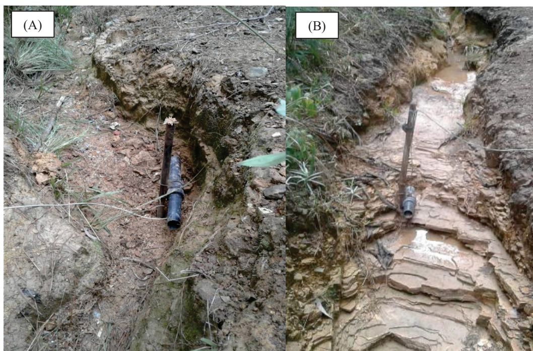
FIGURA 18 - TURBIDÍMETROS INSTALADOS EM CAMPO NO INTERIOR DAS RAVINAS (A) COM PINUS E (B) LINDEIRA, CONECTADOS EM DATALOGGER MARCA WATERLOG , DISPOSTO EM UM POSTE FIXADO NAS PROXIMIDADES
