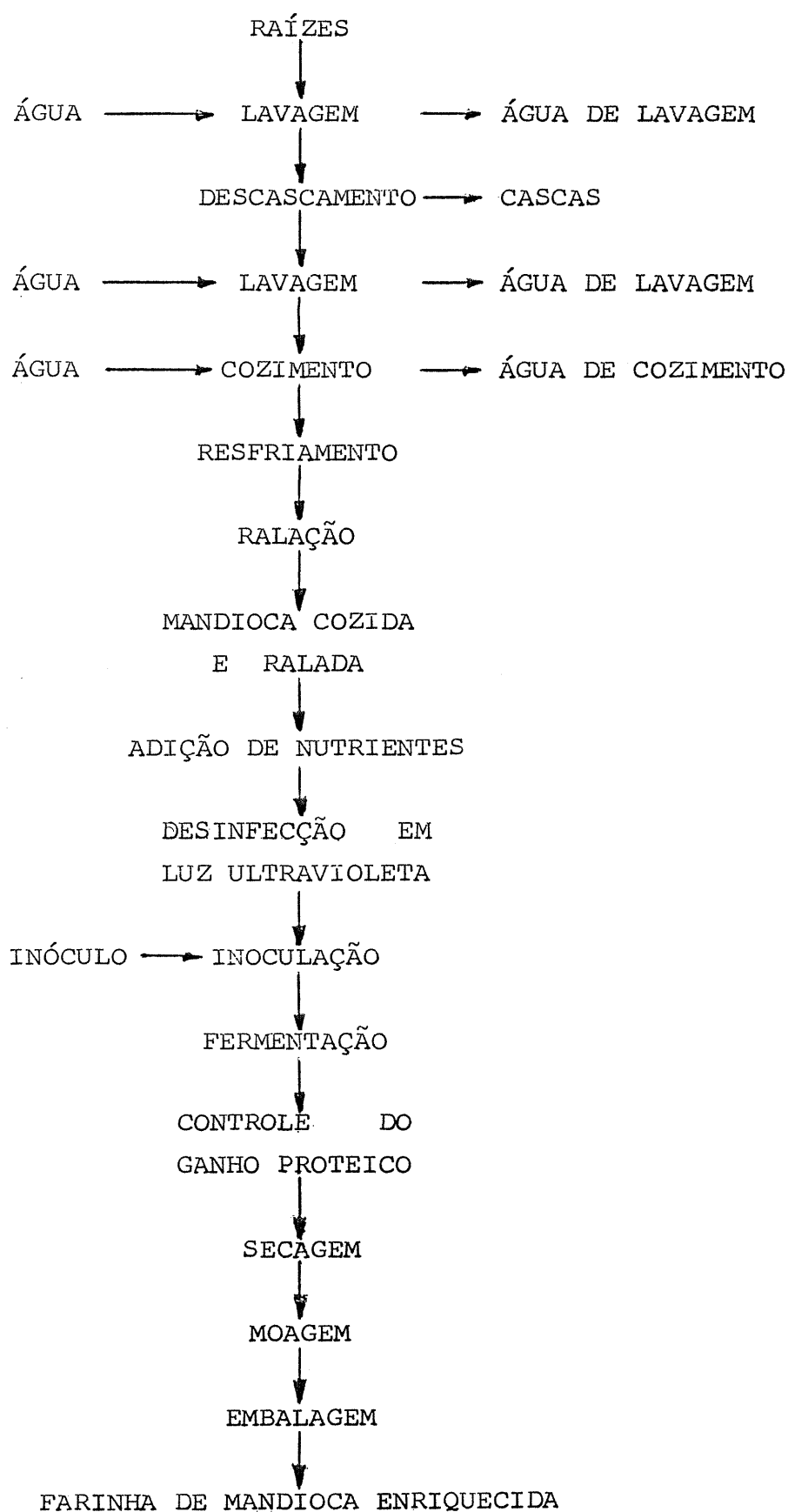
FIGURA 6. Fluxograma de Obtenção da Farinha de Mandioca Enri que cida.
