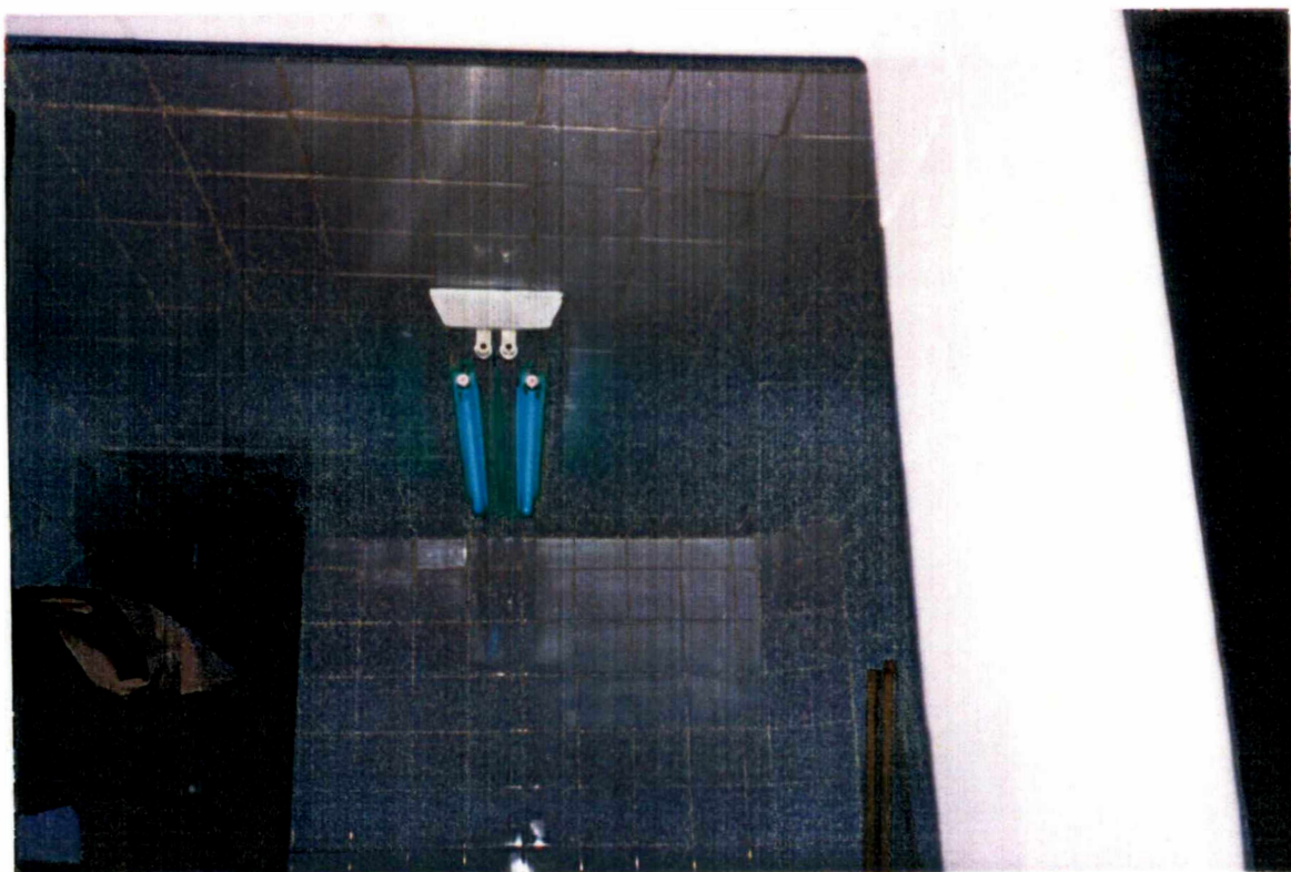
FIGURA 3. Câmara de incubação: lâmpadas ultravioletas.
