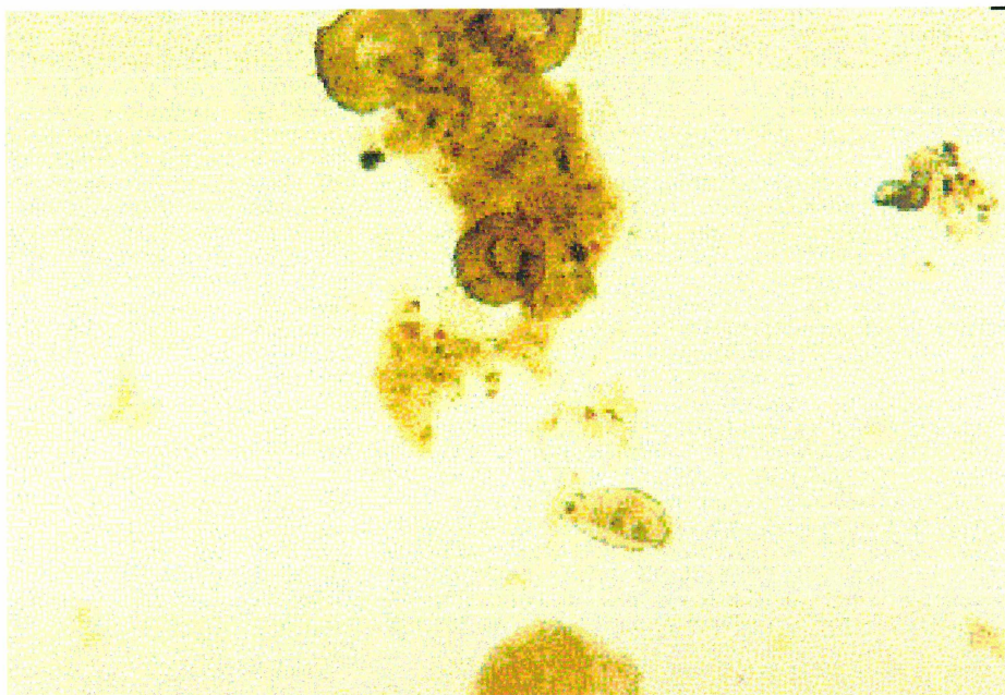
FIGURA 46: Floco de lodo ativado durante tratamento de despejos de abatedouro de aves ( F/M = 0,30 \text{ d}^{-1} ) (100x)
