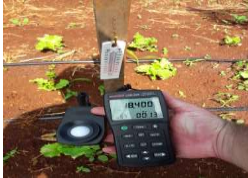
FIGURA 2 – AVALIAÇÃO DA LUMINOSIDADE SOB AS DIFERENTES TELAS DE SOMBREAMENTO AO CENTRO DE CADA TRATAMENTO AFERIDAS NOS HORÁRIOS DE 12:00 hrs E AS 17:00 hrs.
