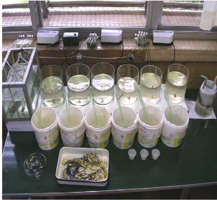
Figura 1. Aparato simples e econômico utilizado em bioensaios com formulações de Bti e larvas de espécies de Simulium .
