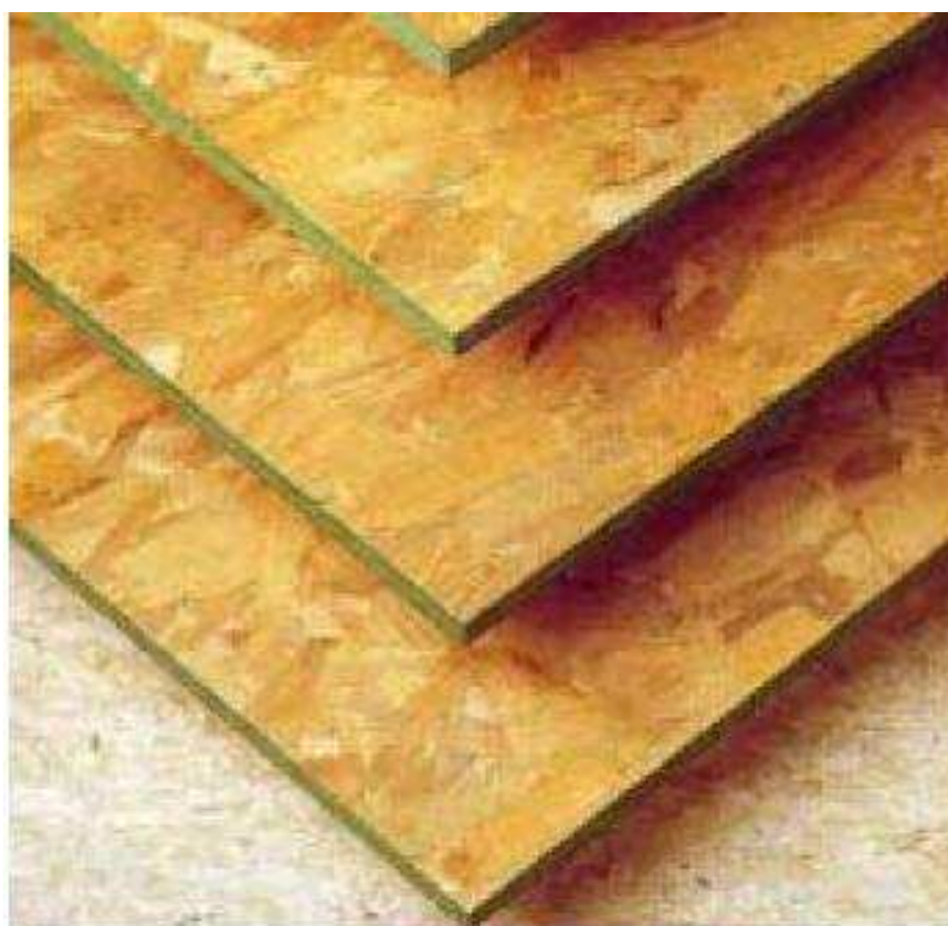
FIGURA 1 - CHAPAS DE OSB, EVIDENCIANDO AS PARTÍCULAS UTILIZADAS
