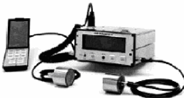
FIGURA 8 - EQUIPAMENTO PARA AVALIAÇÃO NÃO – DESTRUTIVA POR MEIO DE EMISSÃO ULTRA-SOM
