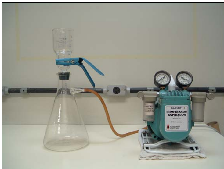
FIGURA 2 – APARELHO USADO PARA FILTRAÇÃO DE AMOSTRAS DE ÁGUA PARA CONCENTRAÇÃO DOS OOCISTOS DE Cryptosporidium parvum
