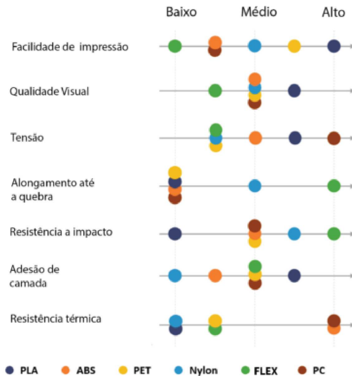
FIGURA 13 – COMPARAÇÃO ENTRE TIPOS DE MATERIAS PARA IMPRESSÃO 3D
