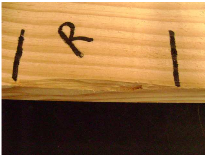
FIGURA 13. Medição da pré-clivagem numa peça S4S originada pelas serras desintegradoras. (O AUTOR)
