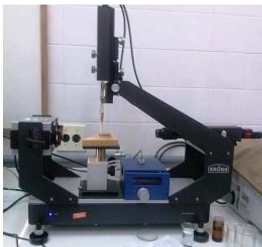
FIGURA 13 - EQUIPAMENTO GONIÔMETRO UTILIZADO PARA MEDIÇÕES DO ÂNGULO DE CONTATO APARENTE
