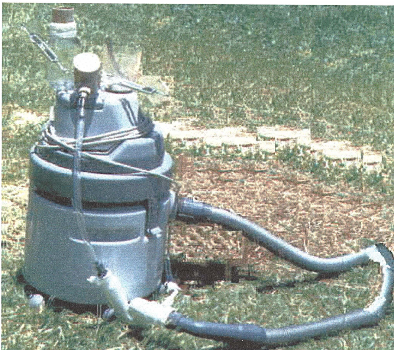
Foto 22 - Conjunto para filtrar água, construído artesanalmente. Observando sobre o aspirador de pó, temos atrás a esquerda, o depósito para água filtrada, constituído por um vidro, com bocal em PVC. Atrás a esquerda, a parte superior, constituído pelo funil, com saída larga onde a água a ser filtrada é colocada. No centro está a base de filtro, construído em PVC, a parte central esbranquiçada é o local sobre o qual vai a membrana filtrante, 'e porosa, construído em fibra de vidro. O aspirador de pó sobre o qual estão as peças do filtro, é utilizado para fazer sucção.
