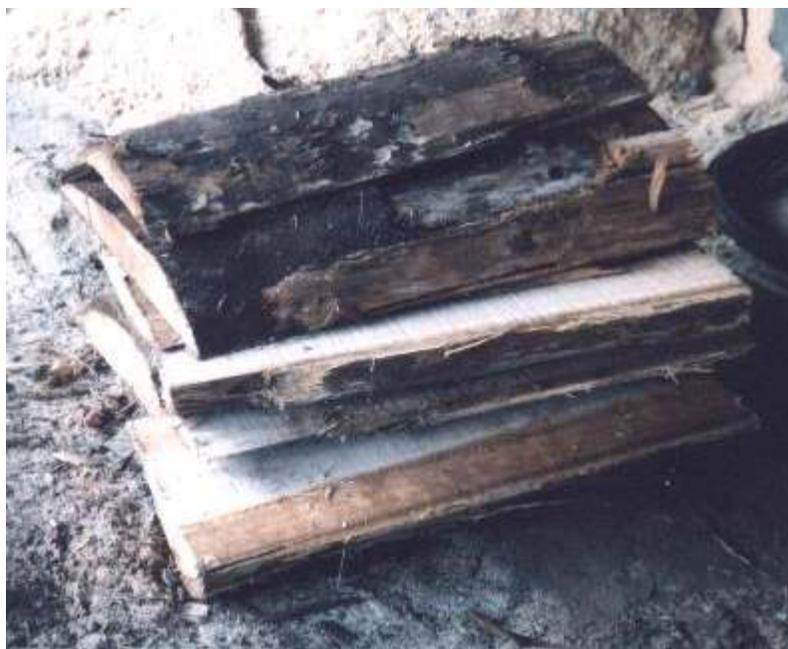
FIGURA 6A – Amostras de costaneiras opostas usadas na avaliação da retratibilidade, resistência à tração paralela e módulo de elasticidade dinâmico no sentido longitudinal
