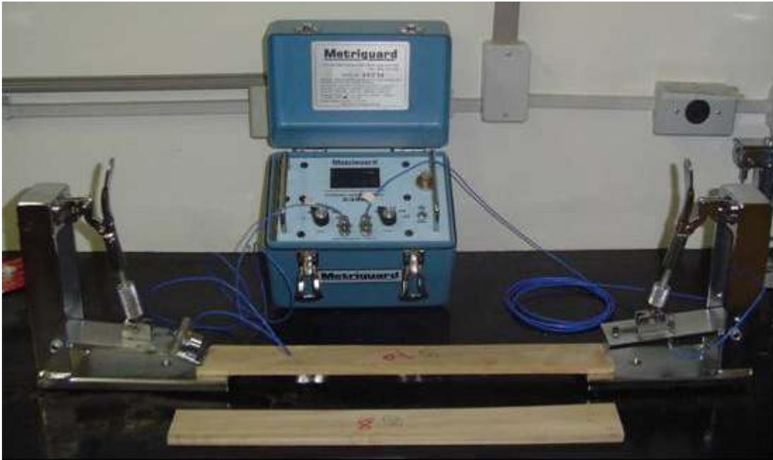
FIGURA 6 – Sistema de aplicação de ondas de tensão modelo Metriguard 239A, mostrando o kit de laboratório (Segunda Etapa)
