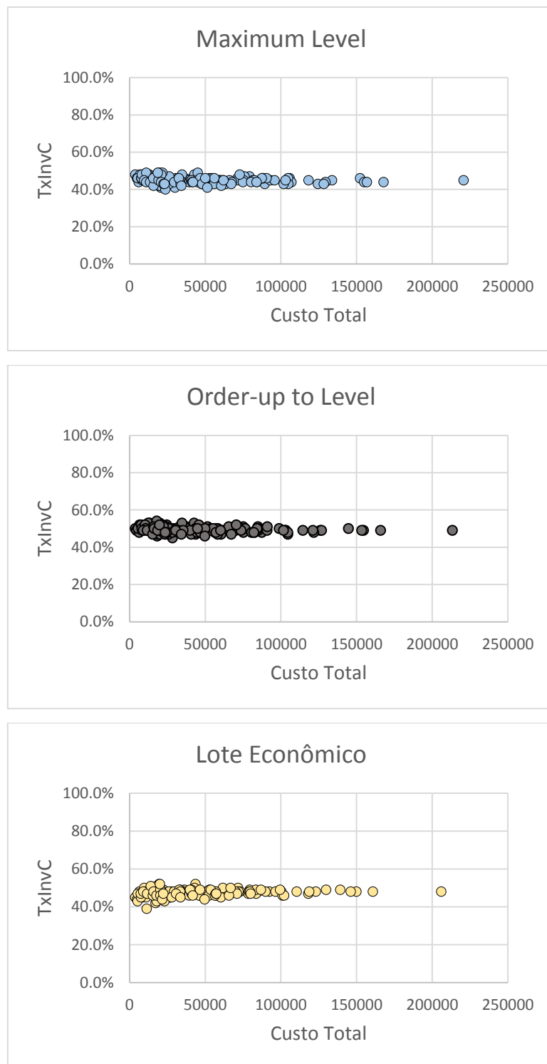
FIGURA 36 – TxInvC PARA A POLÍTICA ML, OU E LE NO PRE ESTOCÁSTICO FONTE: O Autor (2015)
