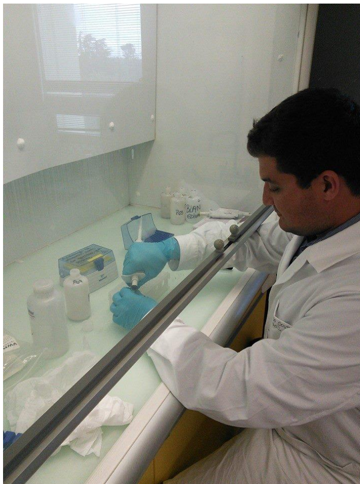
Figura 20 – Processo de adição da solução de phenakita, utilizando micropipetas para inserção de uma quantidade ponderável de ^{10}\text{Be} e fixar uma relação de ^{10}\text{Be}/\text{Be}^9 que será mensurada pelo espectrômetro de massa.
