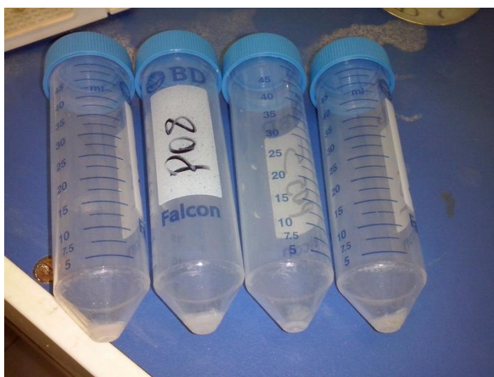
Figura 22 – Tubos contendo apenas os solutos do quartzo, mais a solução de phenakita após o procedimento de dissolução total do quartzo.
