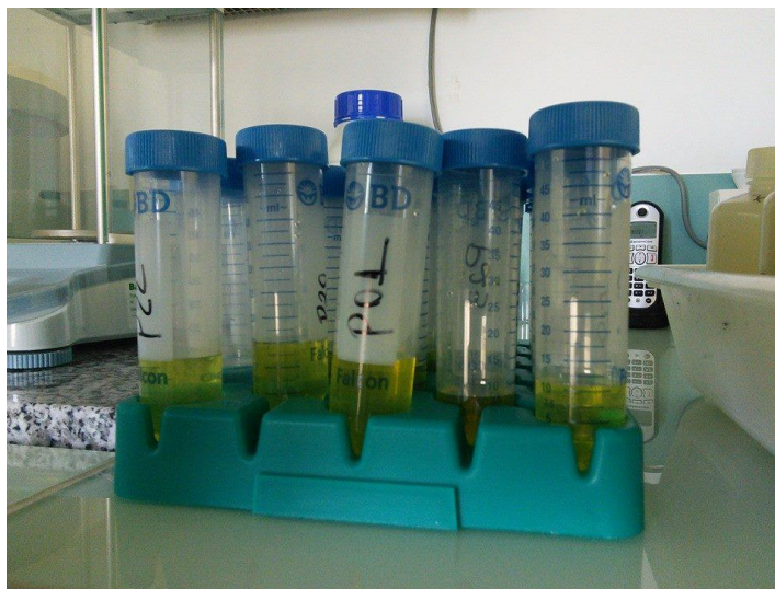
Figura 21 – Tubos contendo as amostras de ^{10}\text{Be}/\text{Be}^9 após a recuperação com ácido clorídrico ( \text{HCl} ) a 7 \text{ mol.L}^{-1} . Fonte: Couto, E.V.
