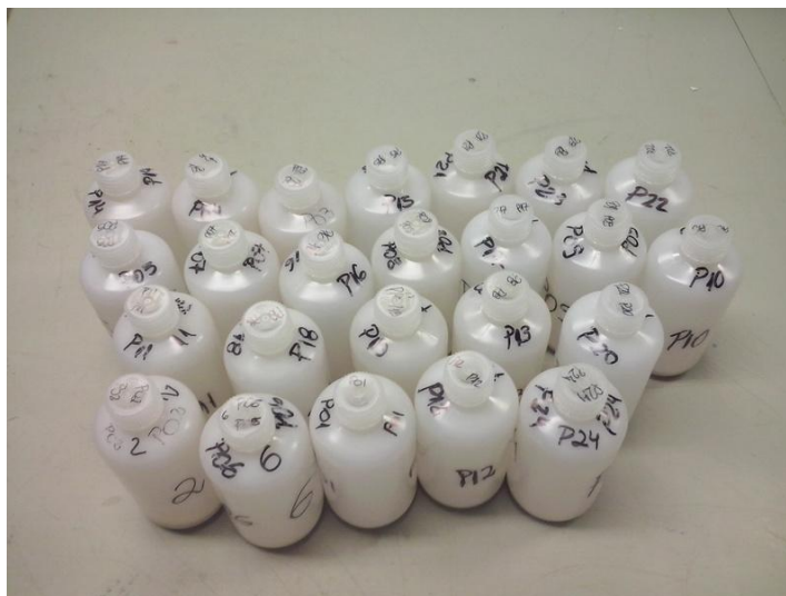
Figura 19 – Frascos de 250 ml do tipo boca estreita contendo aproximadamente 70g de amostras de quartzo em processo de preparação para a primeira purificação do material. Fonte: Couto, E.V.
