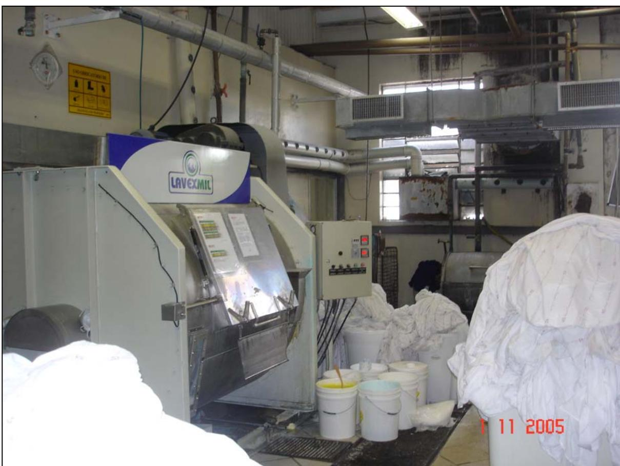
Na “área suja” temos como principais fontes de ruído as próprias máquinas de lavar e o sistema de exaustão. A “área suja” está separada da “área limpa” por divisórias, formando uma barreira com o objetivo de isolar possíveis contaminações das roupas limpas. Por esse motivo, as máquinas de lavar possuem duas aberturas, uma para o lado da “área suja” e outra para o lado da “área limpa”.
