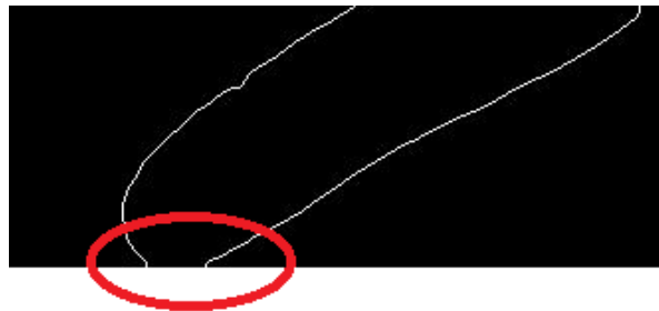
FIGURA 32 – CONTORNO ABERTO DEVIDO AO DEDO ENCOSTADO NA BORDA FONTE: O AUTOR (2015)
