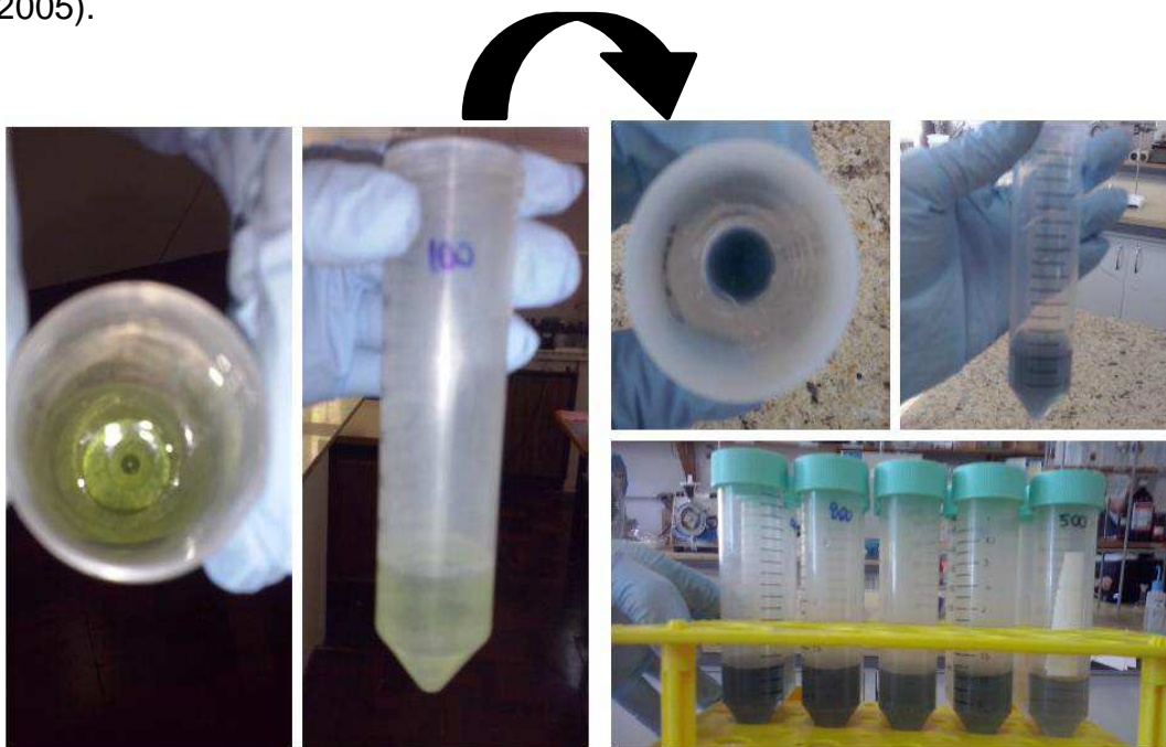
FIGURA 23 - ACOMPANHAMENTO DA MUDANÇA DA COLORAÇÃO NA DETERMINAÇÃO DE POLIFENÓIS TOTAIS FONTE: A AUTORA, 2014
