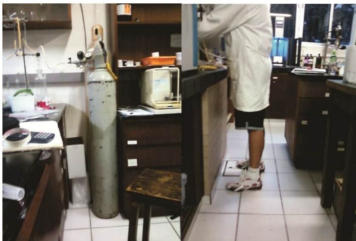
FIGURA 26 – CILINDRO SOLTO E ALUNO COM VESTIMENTA INADEQUADA
