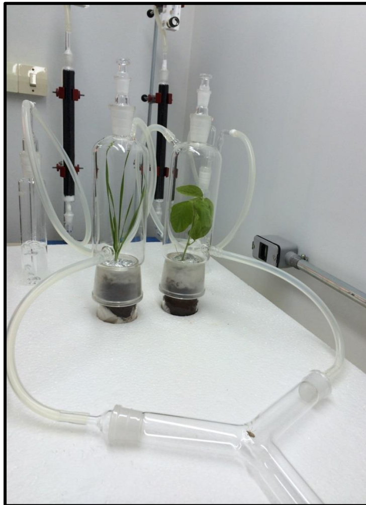
Fig. 7.1. Olfatômetro tipo ‘Y’ contendo plântula de trigo e plântula de soja, para comparação da preferência alimentar do adulto de Dichelops furcatus .
