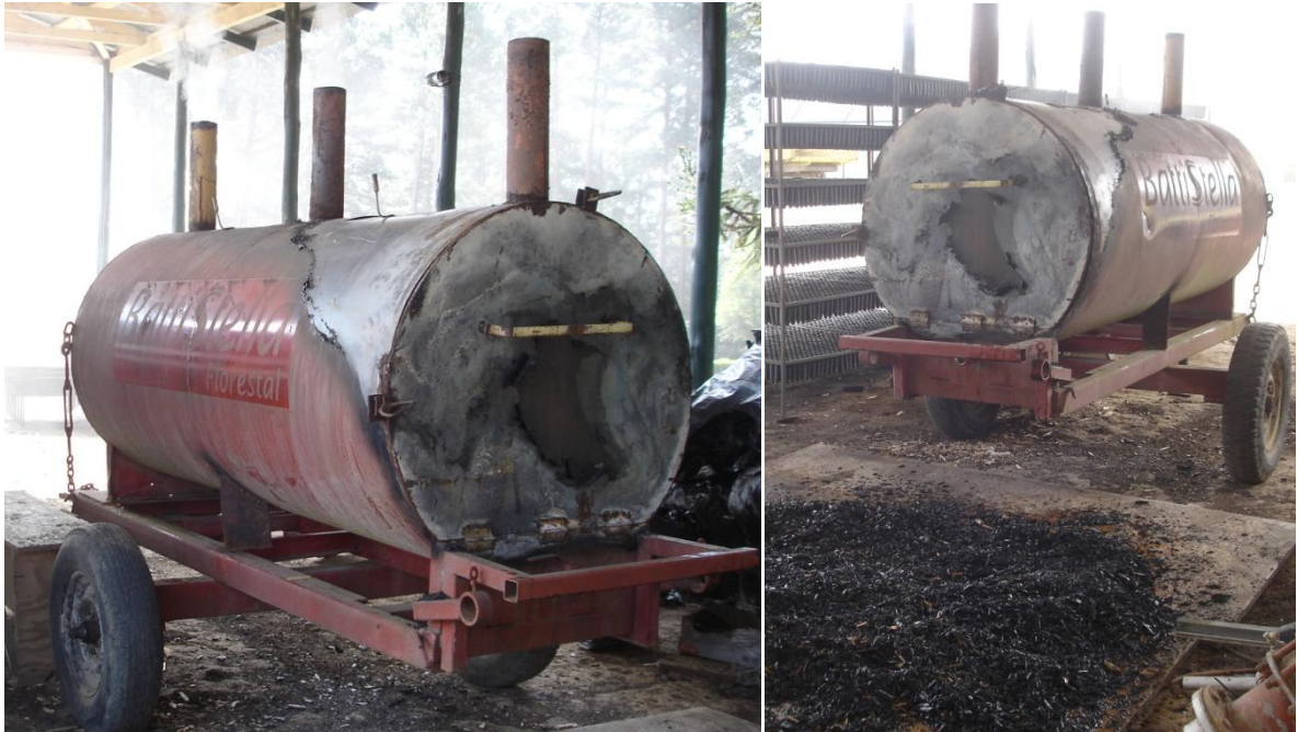
FIGURA 4. FORNO DE PIRÓLISE PARA A PRODUÇÃO DE BIOCÁRVÃO DE CAVACOS DE PINUS FONTE: O autor (2014).
