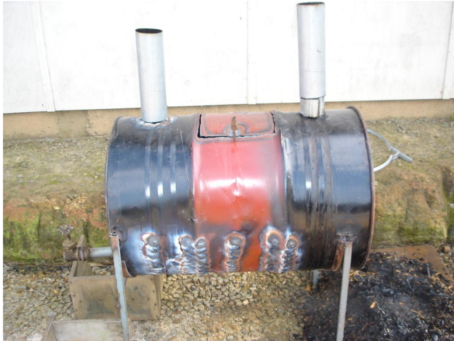
FIGURA 1. FORNO DE PIRÓLISE PARA A PRODUÇÃO DE BIOCARVÃO DE SERRAGEM DE PINUS FONTE: O autor (2014).
