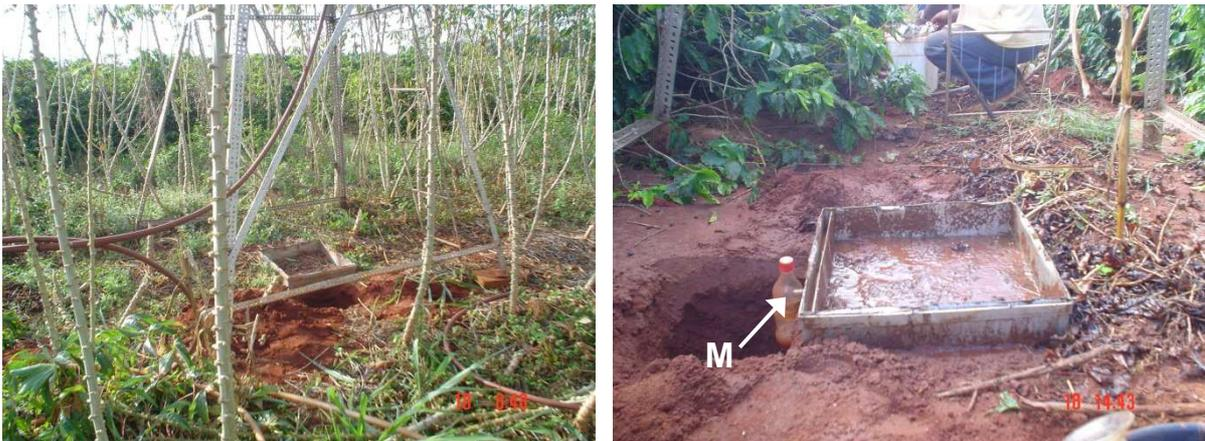
FIGURA 12 – ASPECTOS DA UNIDADE AMOSTRAL INSTALADA NO CENTRO DO SIMULADOR DE CHUVAS.
