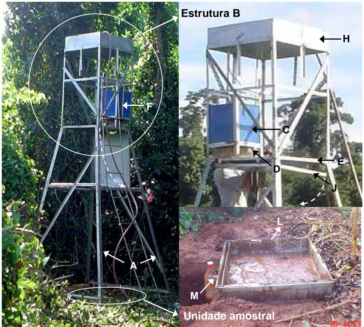
FIGURA 11 – SIMULADOR DE CHUVA. DETALHES DA ESTRUTURA B E DA UNIDADE AMOSTRAL.
