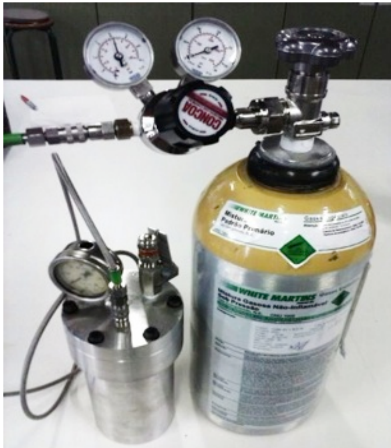
Figura 14. Célula de envelhecimento acelerado e cilindro contendo mistura padrão primário de gás SF_6 e SO_2 .
