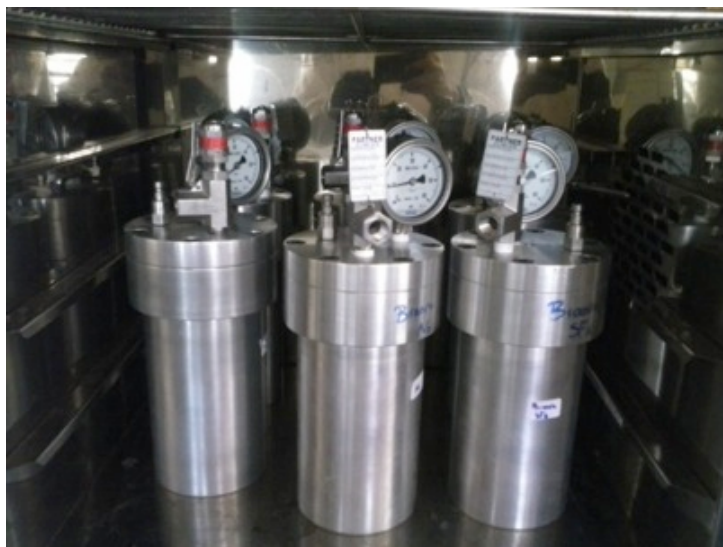
Figura 15. Células dispostas na estufa para início do ensaio de envelhecimento acelerado com as diferentes vedações.
