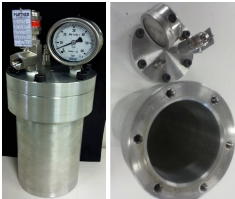
Figura 16. Célula projetada, construída e utilizada nos ensaios de envelhecimento acelerado das vedações testadas nesse estudo.
