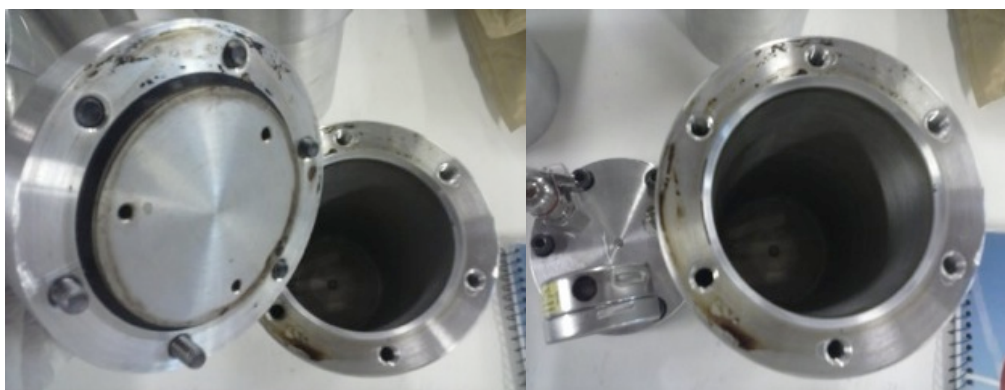
Figura 28. Célula preenchida com SO 2 , que apresentou vazamentos. Em destaque a deformação permanente do o-ring de vedação da tampa.
