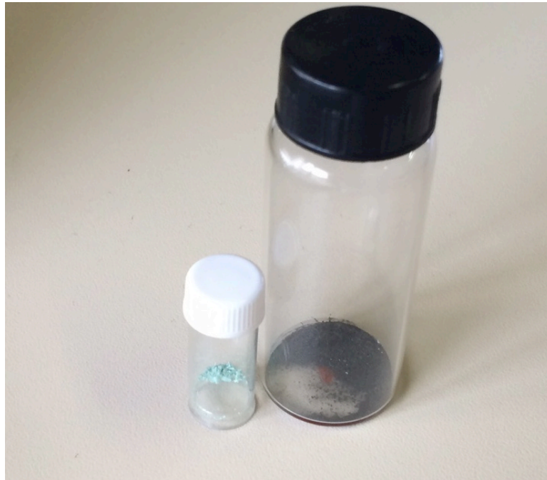
Figura 6. Subprodutos sólidos em pó recolhidos de equipamentos elétricos isolados a SF 6 . Fonte: O autor, 2014.
