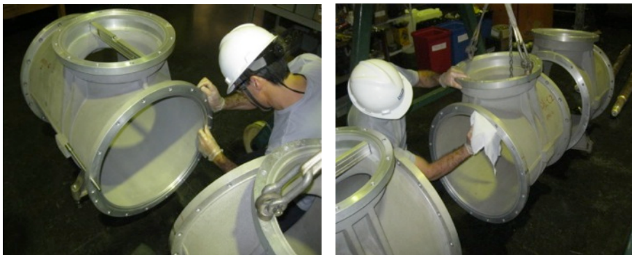
Figura 36. . Etapas da montagem dos compartimentos que contém o gás SF 6 .
