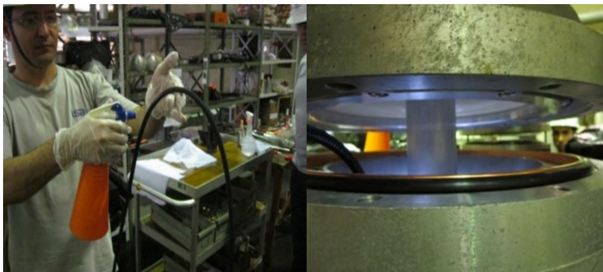
Figura 37. Detalhe pré-montagem e detalhe da junção do tipo flange configurada com todos os elementos de vedação em posição de acoplamento.
