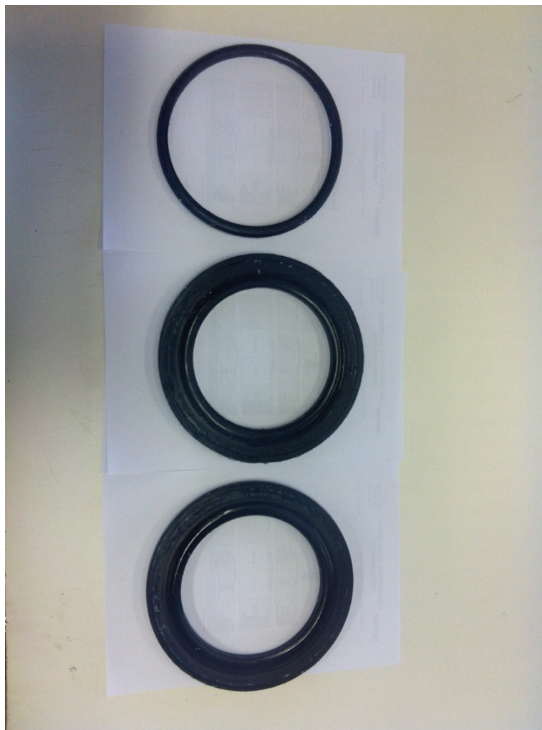
Figura 8. O-ring (topo) e gaxetas (intermediária e inferior) utilizadas em disjuntores de alta tensão, confeccionadas em borracha para vedação de gás-ar. Fonte: O autor, 2013.
