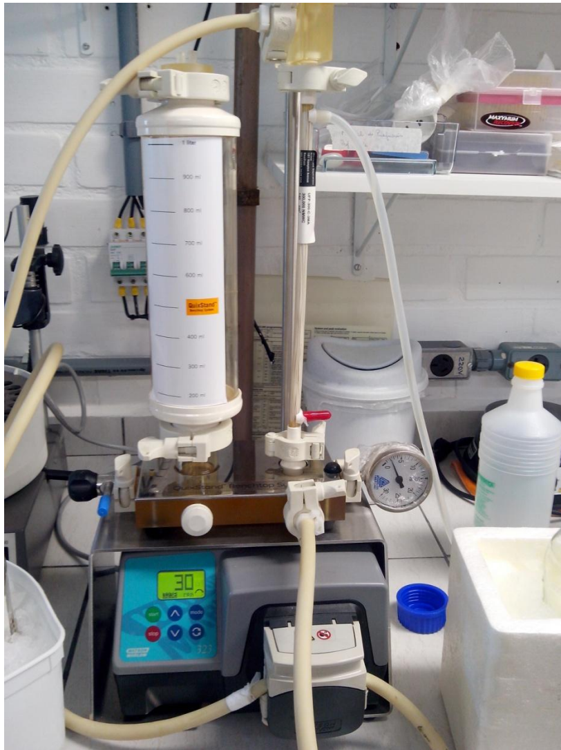
FIGURA 12 – SISTEMA HOLLOW FIBER QUIXSTAND (GE, SUÉCIA). FONTE: O AUTOR, 2014
