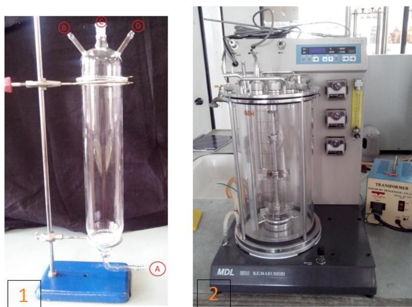
FIGURA 33 – (1) - BIORREATOR DO TIPO COLUNA DE BOLHAS, UTILIZADO PARA A PRODUÇÃO DE CELULASES. (2) – BIORREATOR DO TIPO TANQUE AGITADO (STR)
