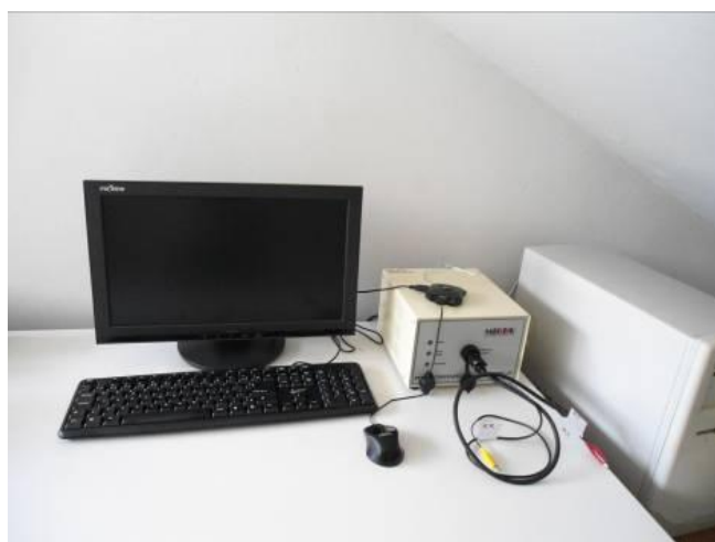
Figura 10: Potenciostato microquímica MQPG-01 e o computador com o qual está interfaceado.
