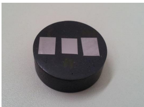
Figura 12: Amostras de Tântalo após embutimento, lixamento e polimento.
