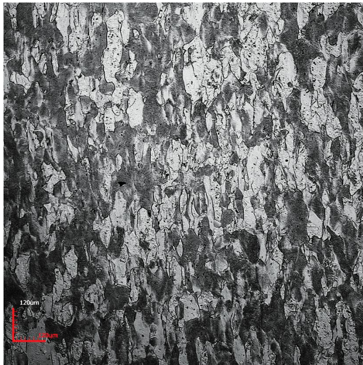
Figura 13: Micrografia do Tântalo. A barra de escala tem dimensão de 120 \mu\text{m} .
