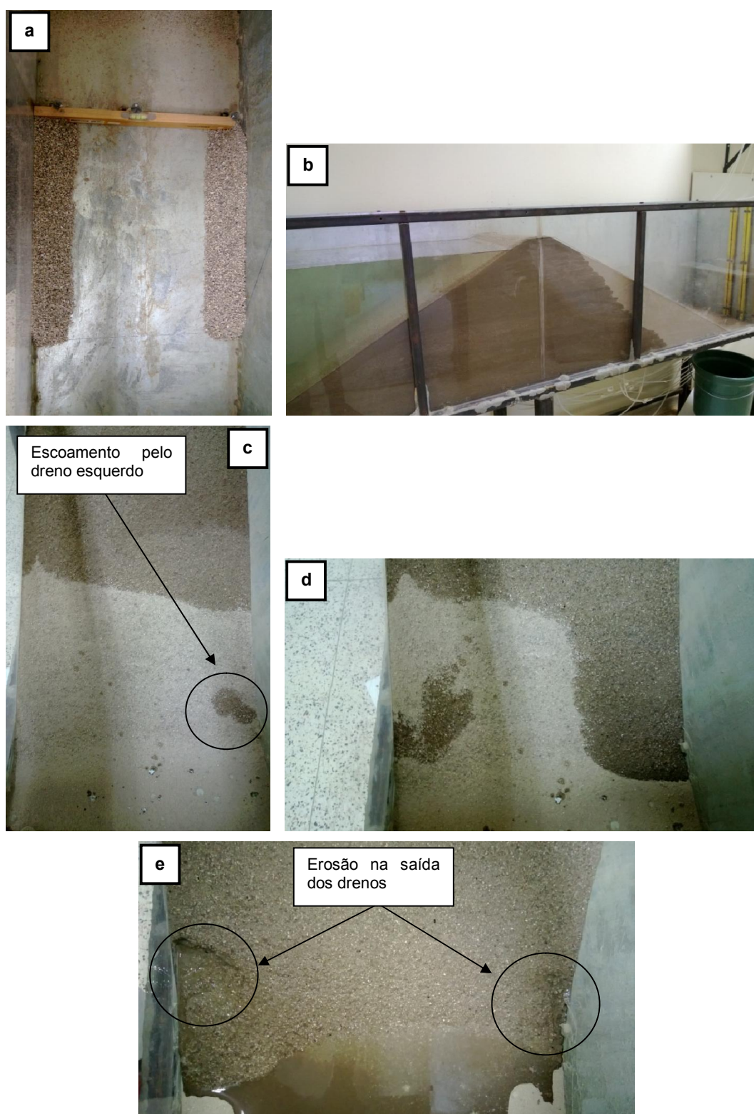
FIGURA 4.16 – Simulação do modelo físico 3: a) disposição dos drenos franceses; b) percolação da água pelo maciço; c) e d) início da saída d'água pelos drenos; e) erosão na saída nos drenos
