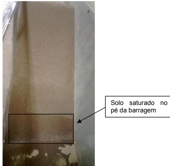
FIGURA 4.8 – Drenagem do fluxo pelo tapete drenante, com saturação no pé de jusante da barragem
