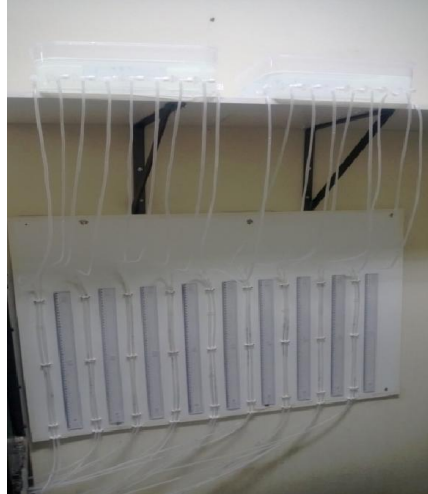
FIGURA 3.14 – procedimento utilizado para saturação dos piezômetros
