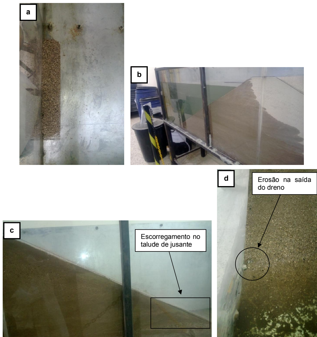
FIGURA 4.11 – Simulação do modelo físico 2: a) disposição do dreno francês; b) percolação da água pelo maciço; c) leve escorregamento no talude de jusante; d) erosão na saída do dreno
