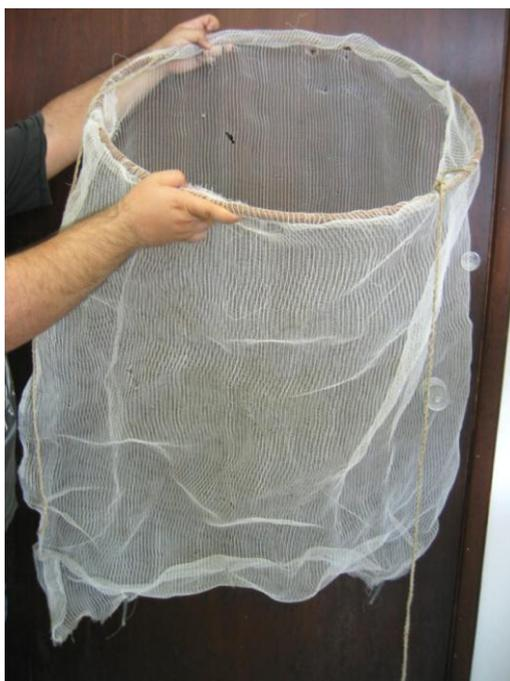
FIGURA 6 – Rede utilizada para envolver as lanternas e diminuir a perda de organismos.
