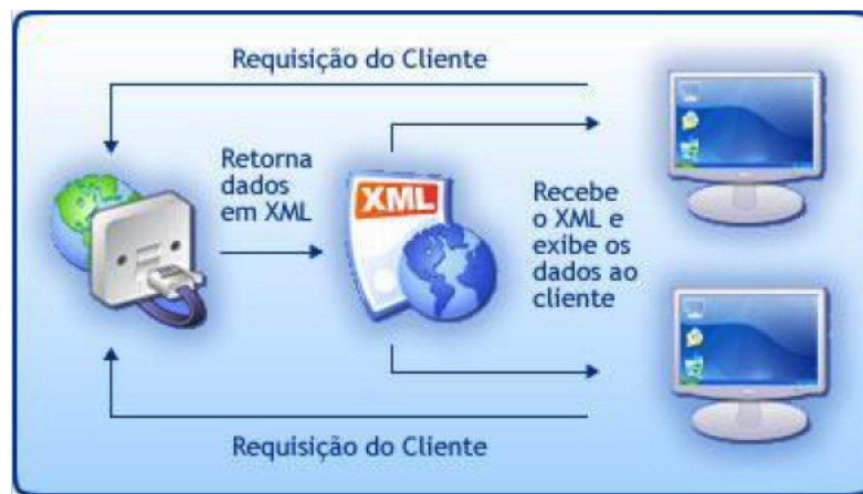
Figura 1: Funcionamento de um Webservice .
