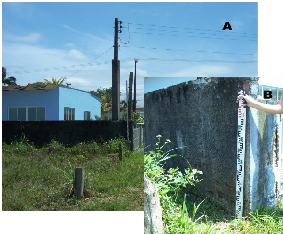
FIGURA 8: LOCALIZAÇÃO DOS PONTOS FIXOS, RÉS, DO PERFIL COROADOS. IMAGEM A , MOSTRA O ALINHAMENTO DO MURO COM OS PILARES DE CONCRETO; A IMAGEM B MOSTRA A QUINA DO MURO, QUE SERVIU DE ZERO RELATIVO PARA ESSE PERFIL.
