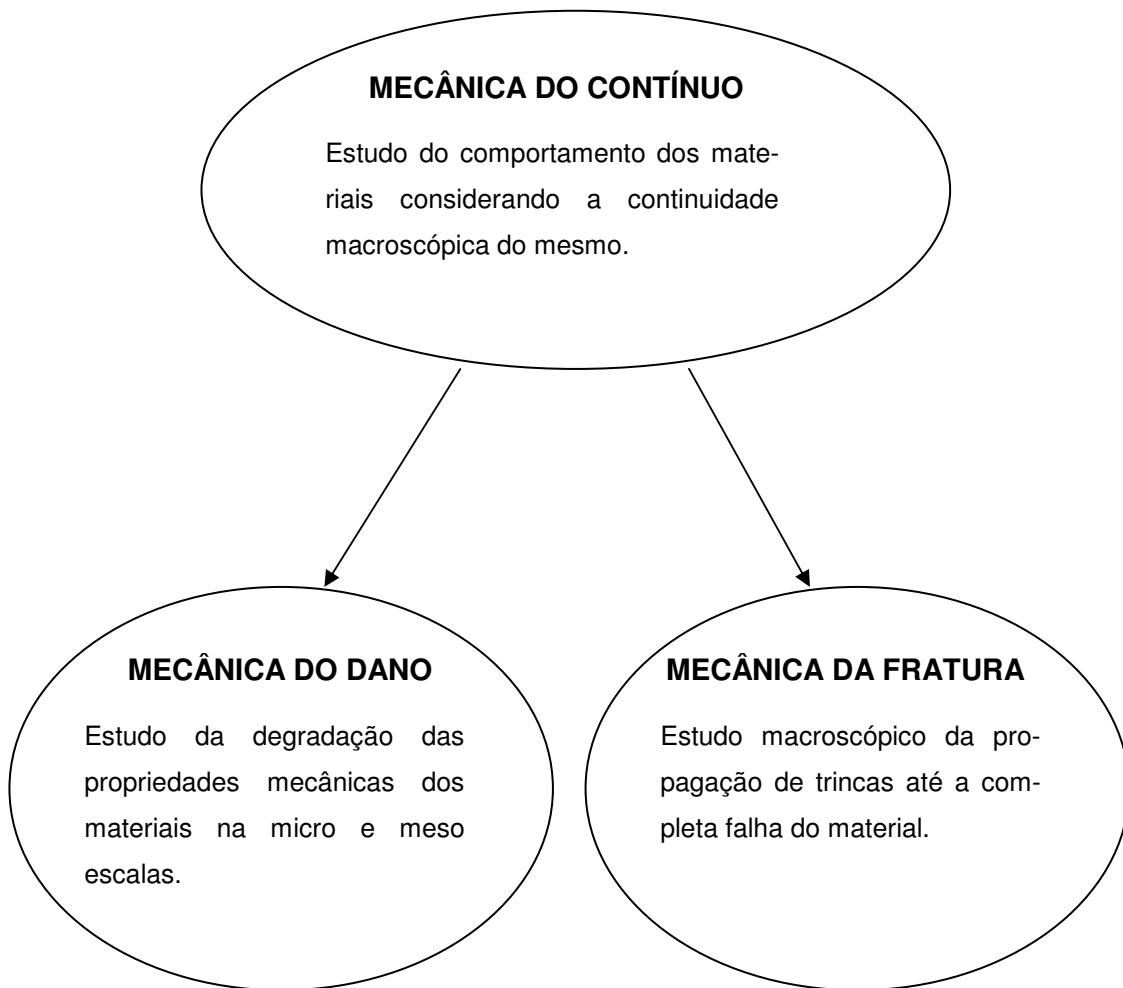
Figura 22 – Abordagem esquemática do comportamento mecânico dos materiais.
