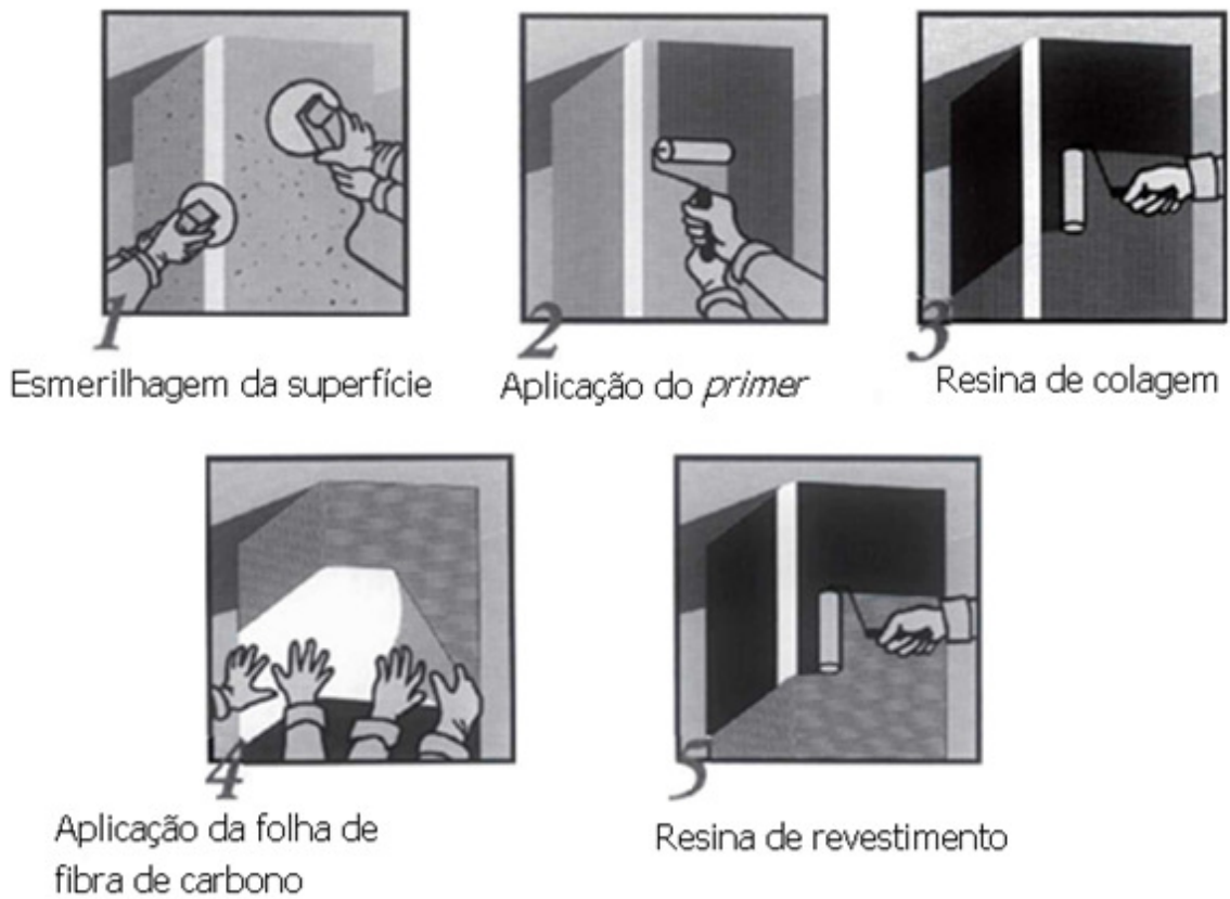
Figura 18 – Processo de aplicação de mantas flexíveis de CFRP.
