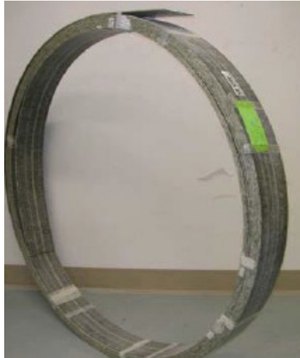
Figura 14 – Rolo comercial de lâminas de fibra de carbono. FONTE: Obaidt (2007).
