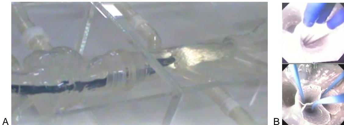
FIGURA 16 – FOTO DO MODELO DE ANEURISMA DE SILICONE COM POSICIONAMENTO DO ENDOSCÓPIO (A). FOTO DO DISPARO DOS STENTS REVESTIDOS (B) FONTE: acervo do autor Coris Cirurgia Vascular e Endovascular
