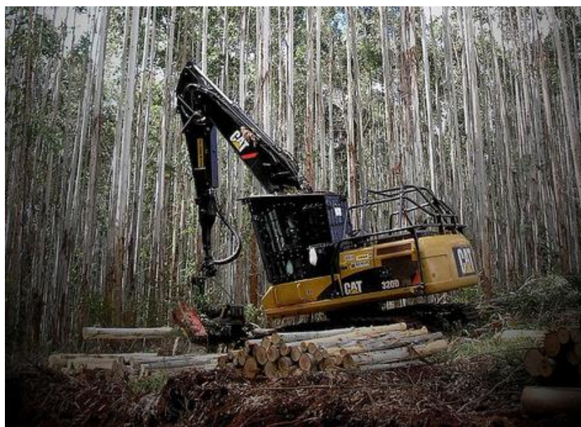
Figura 4 Harvester utilizado para o corte e processamento da madeira
