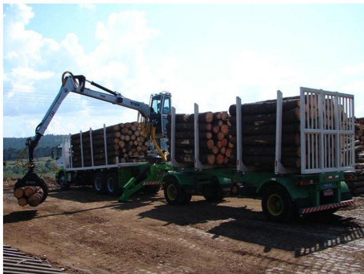
Figura 6 Caminhão auto carregável utilizado na etapa de transporte da madeira para a planta de carbonização (Fonte: www.tmo.com.br )
