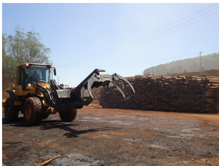
Figura 9 Carregadeira utilizada na etapa de carregamento do forno
