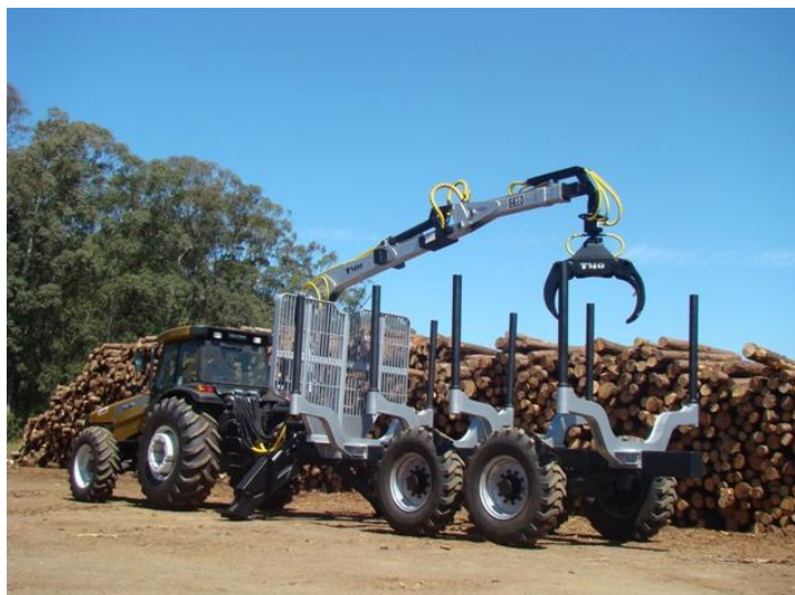
Figura 5 Trator florestal auto carregável Valtra BH 180 utilizado na etapa de baldeio (Fonte: www.tmo.com.br )
