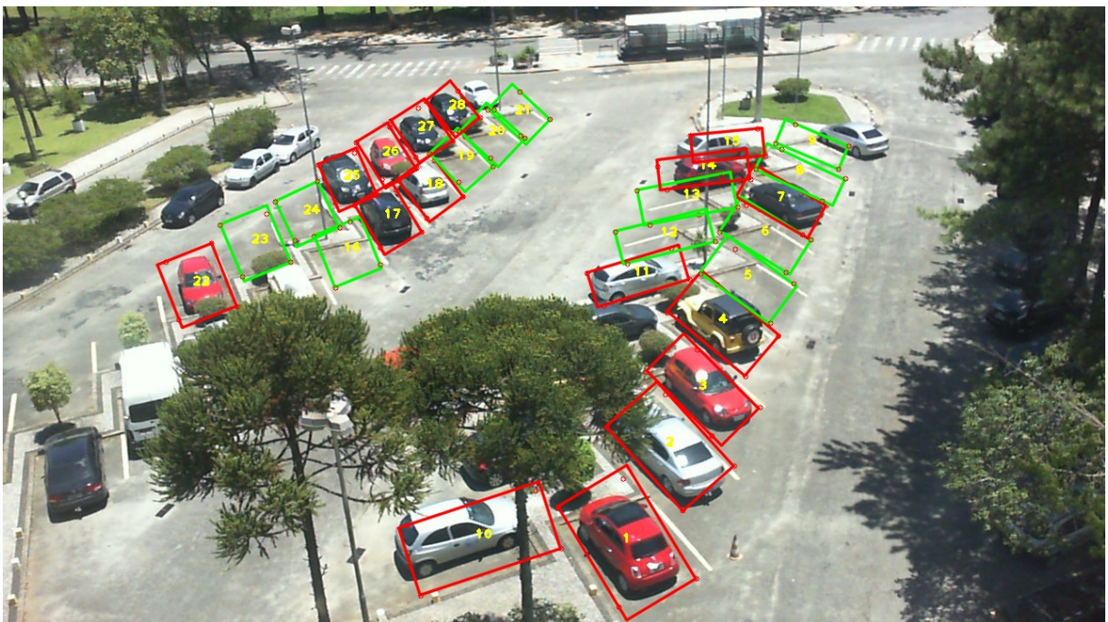
Figura 4.8: Exemplo de segmentação de uma imagem de estacionamento
