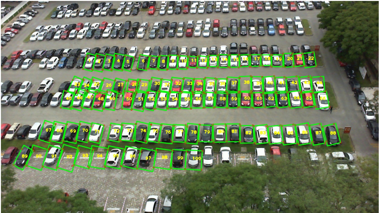
Figura 4.12: Vagas Segmentadas no estacionamento PUCPR
