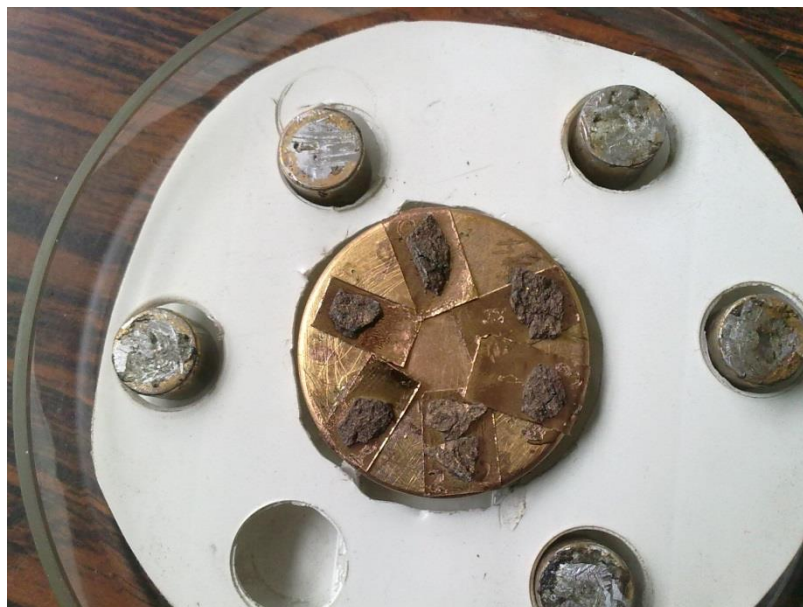
FIGURA 2 - AMOSTRAS DOS CORPOS DE PROVA METALIZADOS COM OURO. FONTE: AUTOR, 2012.
