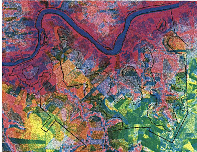
Figura 46 - IMAGEM TRANSFORMADA IHS ASSOCIADA AO PICTOGRAMA COM AS UNIDADES DE MAPEAMENTO DIGITALIZADAS
