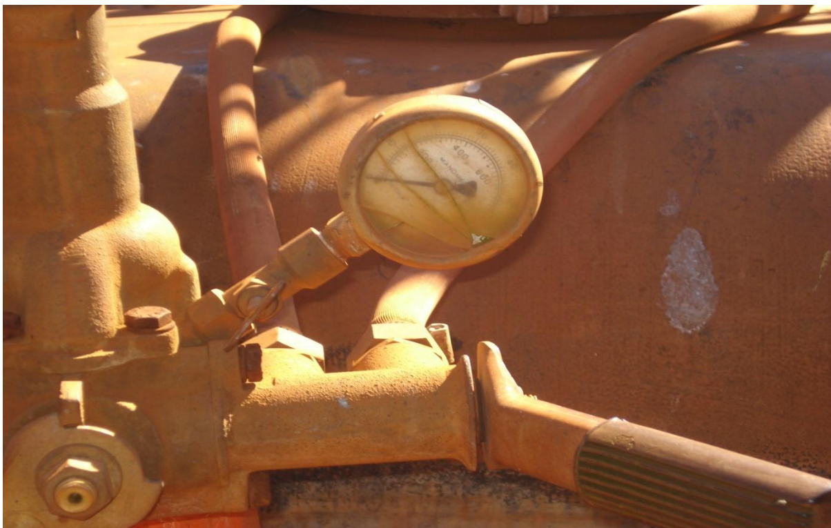
FOTO 11 - PULVERIZADOR DE BARRA COM MANÔMETRO QUEBRADO EM PRORIEDADE RURAL DO BAIRRO ÁGUA DE SANTA MARIANA FONTE: O autor (2010)
