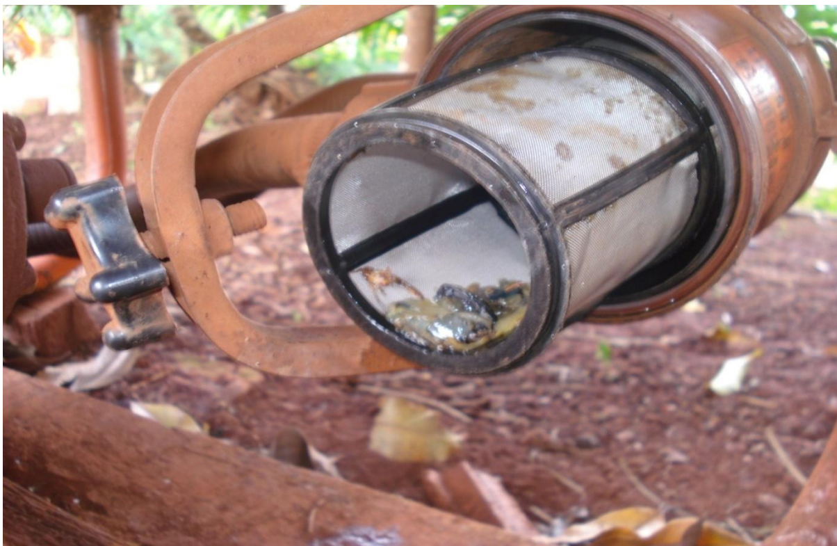
FOTO 13 – FILTRO PRINCIPAL DE UM PULVERIZADOR DE BARRA EM PROPRIEDADE RURAL DO BAIRRO ÁGUA DE SANTA MARIANA EVIDENCIANDO A FALTA DE MANUTENÇÃO
