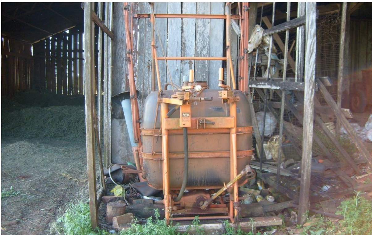
FOTO 10 – PULVERIZADOR DE BARRA VELHO E SEM MANUTENÇÃO ARMAZENADO A CÉU ABERTO EM PROPRIEDADE RURAL DO BAIRRO AGUA DE SANTA MARIANA FONTE: O autor (2010)
