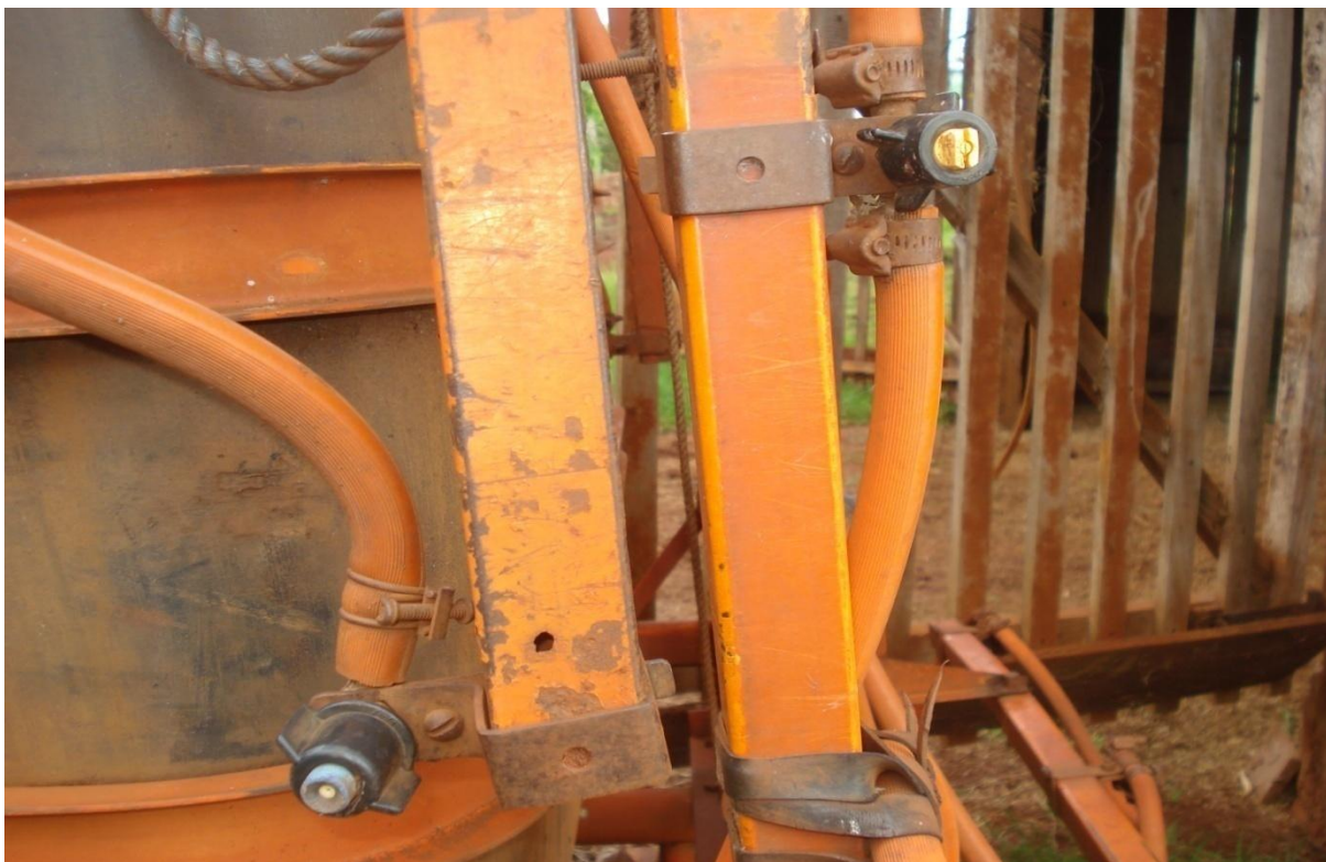
FOTO 12 – PULVERIZADOR DE BARRA DO BAIRRO RURAL ÁGUA DE SANTA MARIANA COM PONTAS DE PULVERIZAÇÃO DE TIPOS DIFERENTES FONTE: O autor (2010)
